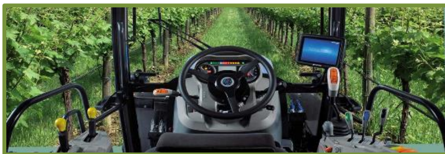
Figura 81 :interno cabina trattore con strumentazione per l'agricoltura di precisione.
