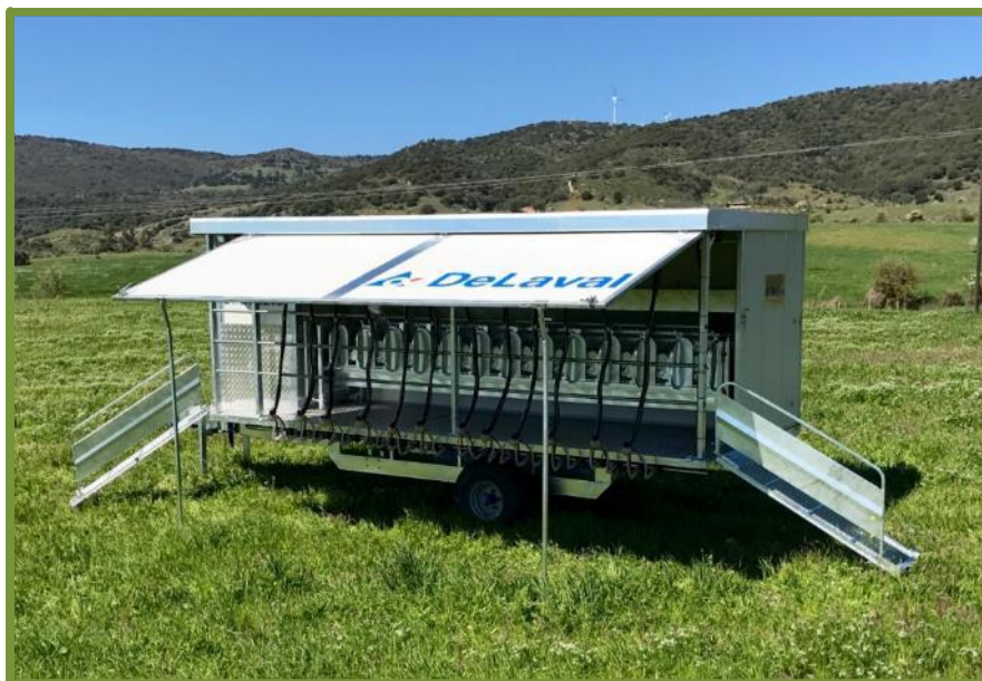
Figura 80: carro di mungitura trasportabile. Fonte: http://www.cmdmilking.com/
