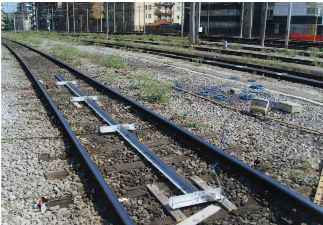
Figura 6: Binario attrezzato con l'apparecchiatura di monitoraggio
