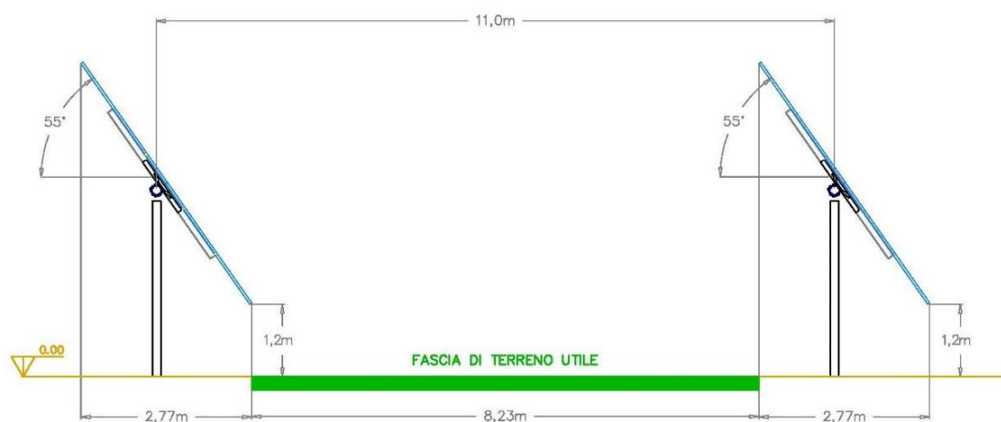
Fig. 5.1 - Particolare tracker con rotazione massima (55° verso est) (l'altezza da terra è da considerarsi a titolo di esempio)
