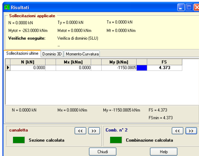
Figura 3.5: Verifica di resistenza COMB SISMICA - SLU
