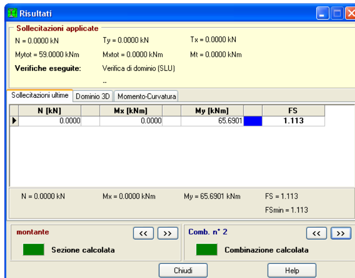
Figura 3.13: Verifica di resistenza COMB SISMICA - SLU
