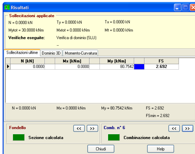
Figura 3.20: Verifica di resistenza COMB FOND - SLU
