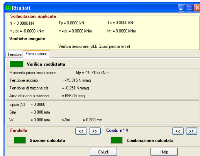
Figura 3.19: Verifica fessurazione QUASI PERM - SLE
