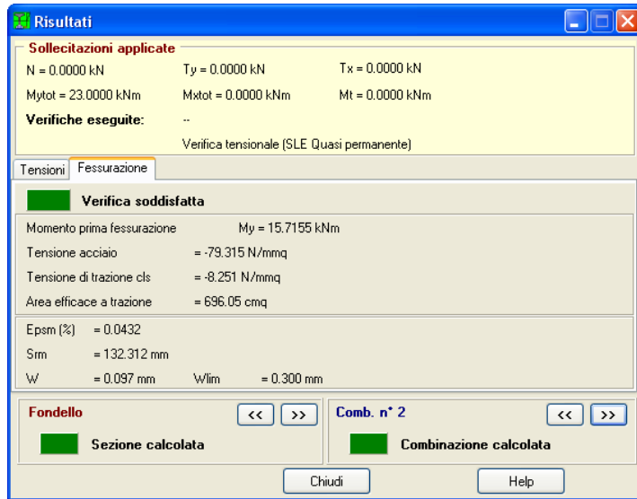
Figura 3.23: Verifica fessurazione QUASI PERM - SLE
