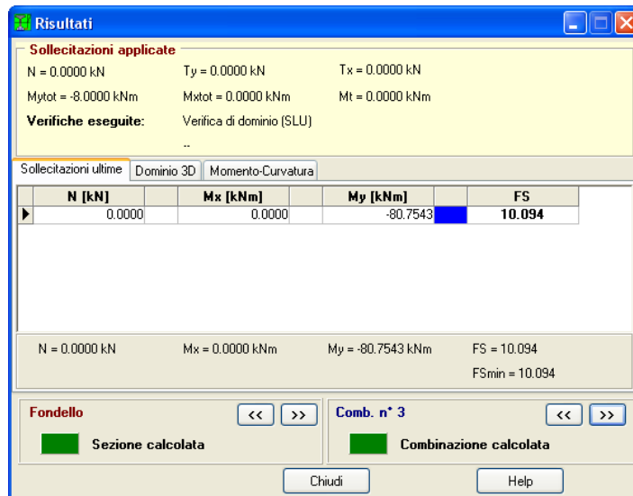
Figura 3.16: Verifica di resistenza COMB FOND - SLU
