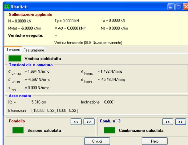
Figura 3.18: Verifica tensionale QUASI PERM - SLE
