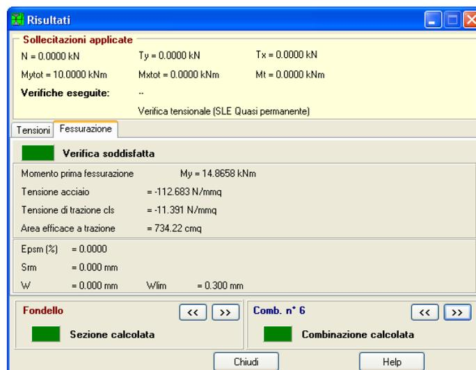
Figura 3.23: Verifica fessurazione QUASI PERM - SLE
