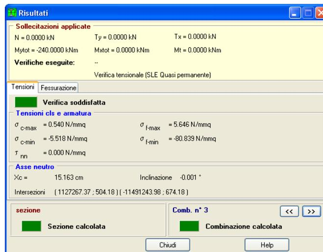
Figura 3.6: Verifica tensionale QUASI PERM - SLE
