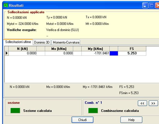
Figura 3.4: Verifica di resistenza COMB FONDS - SLU
