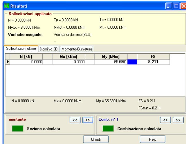
Figura 3.12: Verifica di resistenza COMB FOND - SLU
