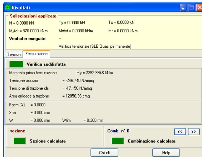
Figura 3.11: Verifica fessurazione QUASI PERM - SLE
