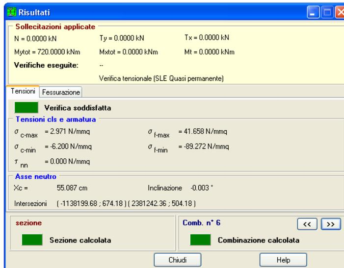
Figura 3.10: Verifica tensionale QUASI PERM - SLE
