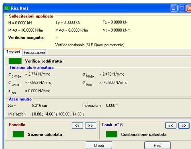
Figura 3.22: Verifica tensionale QUASI PERM - SLE
