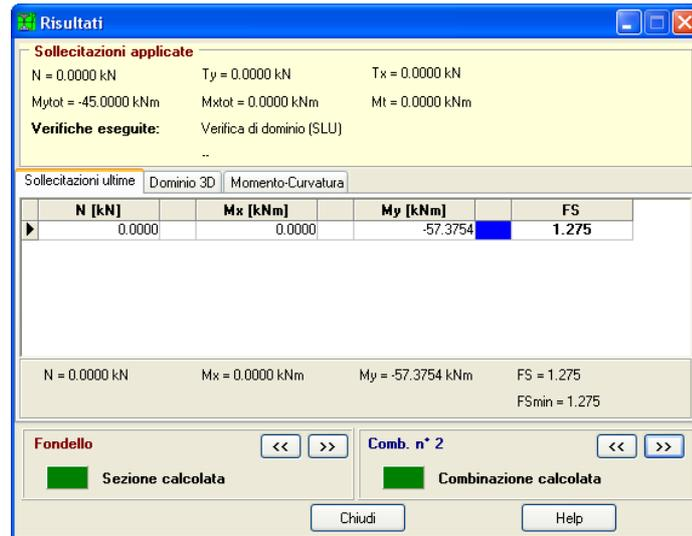
Figura 3.17: Verifica di resistenza COMB SISMICA – SLU
