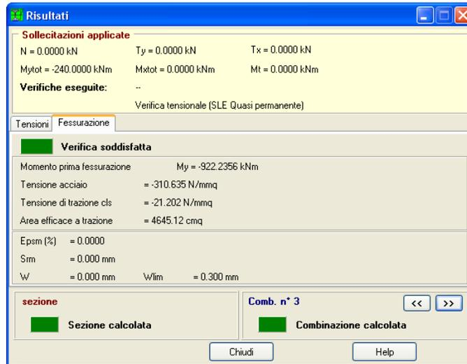
Figura 3.7: Verifica fessurazione QUASI PERM - SLE
