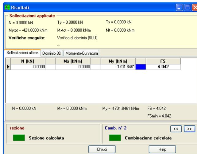
Figura 3.5: Verifica di resistenza COMB SISMICA - SLU
