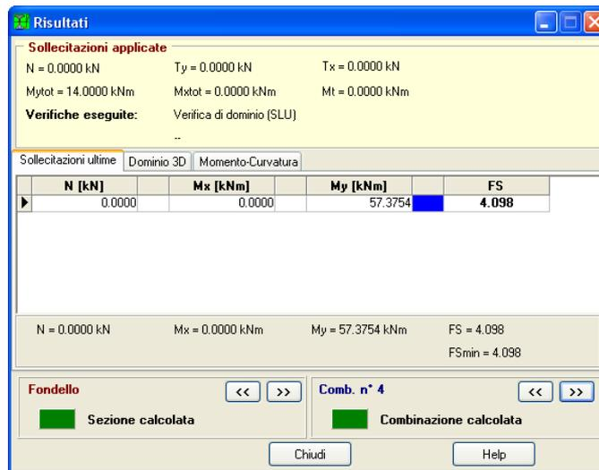
Figura 3.20: Verifica di resistenza COMB FONDS - SLU
