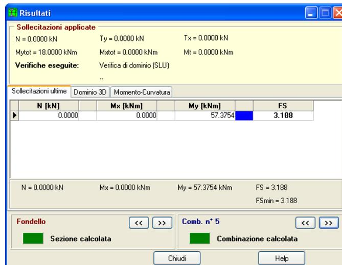
Figura 3.21: Verifica di resistenza COMB SISMICA - SLU
