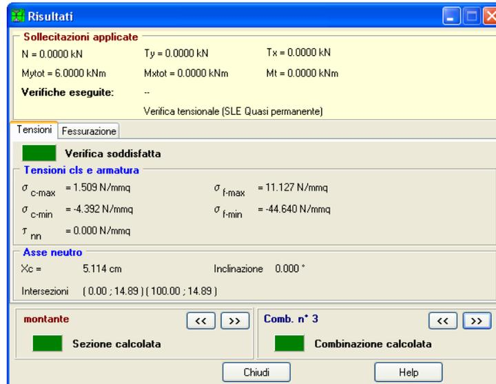
Figura 3.14: Verifica tensionale QUASI PERM - SLE
