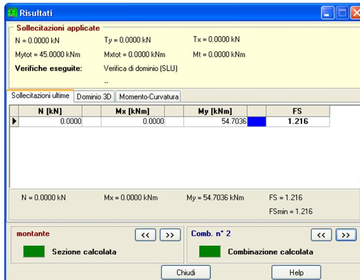
Figura 3.13: Verifica di resistenza COMB SISMICA - SLU
