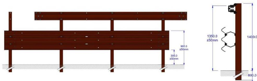
Gli elementi in acciaio saranno realizzati in acciaio Corten il quale rispetto all'acciaio tradizionale risulta essere più vantaggioso in termini di sostenibilità ambientale, possedendo comunque caratteristiche meccaniche comparabili.
