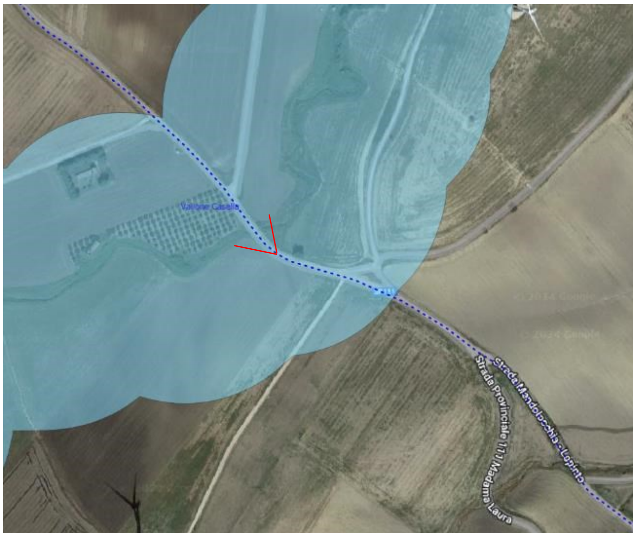
Figura 47 – Interferenza del tracciato del cavidotto interrato esterno con area mappata come “Fiumi torrenti e corsi acqua e relativo buffer di 150m”, con indicazione del punto di ripresa fotografica
