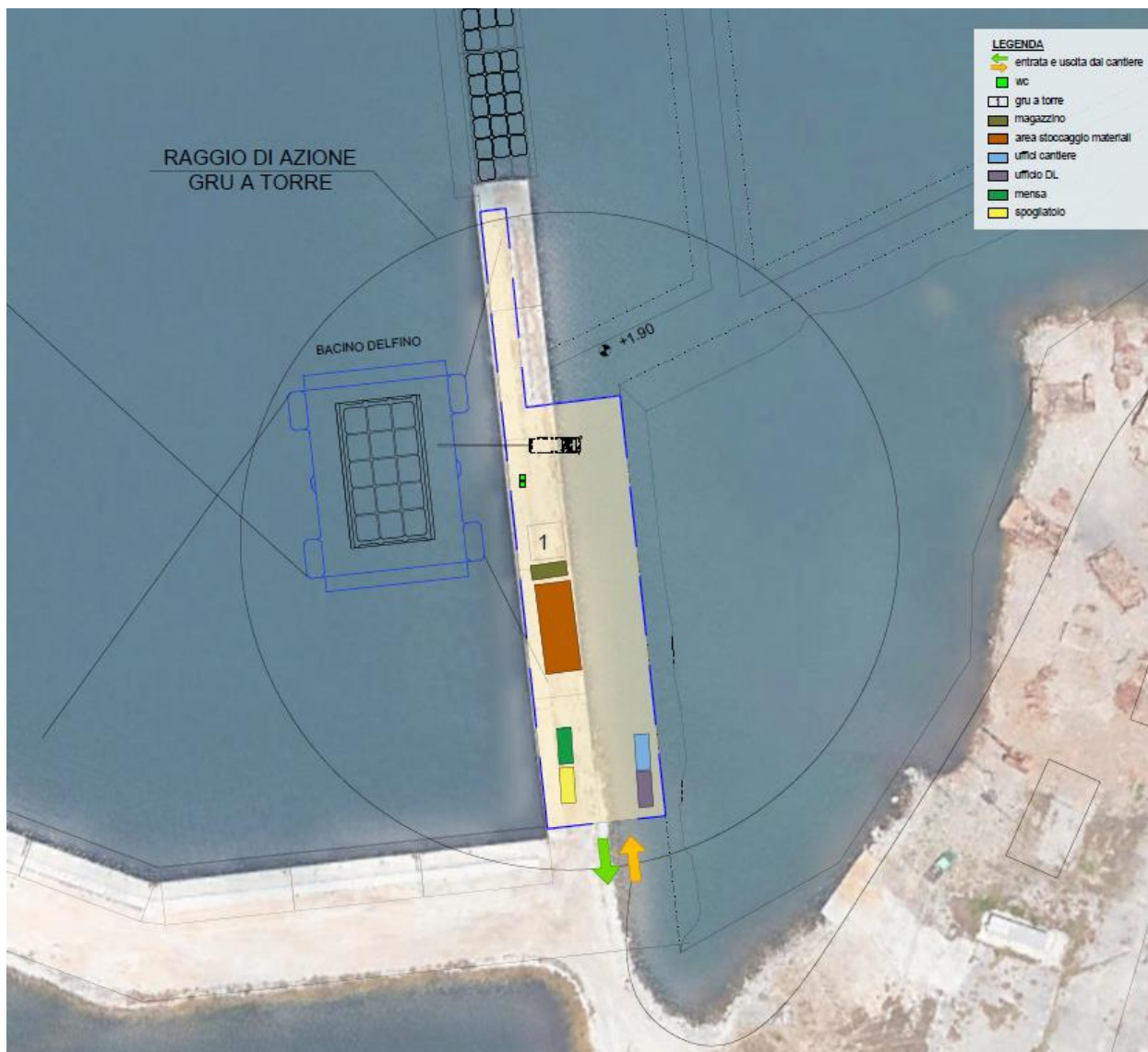
Figura 11-6 – Area di prefabbricazione cassoni cellulari e ormeggio bacino galleggiante Delfino nel Porto di Bari
