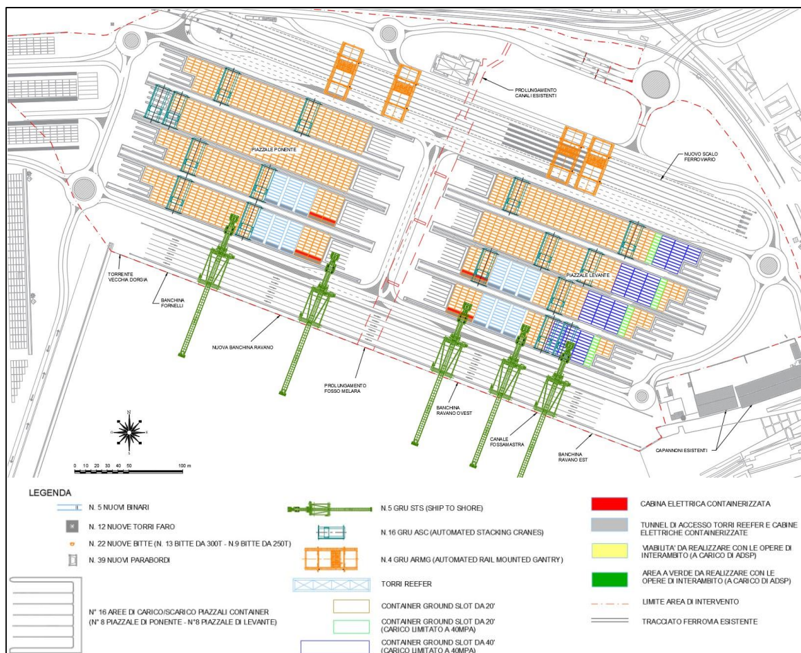
Figura 1.1 – Nuovo terminal Ravano - Planimetria di progetto
