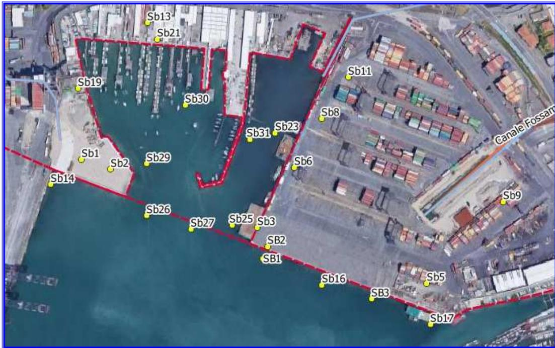
Figura 5 – Ubicazione dei sondaggi realizzati nell'ambito del PFTE
