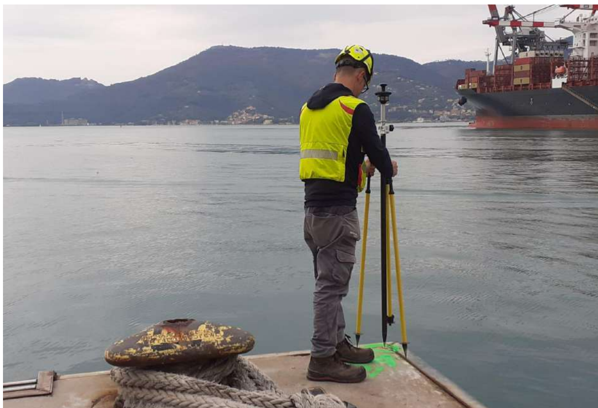
Misura di punti (coordinate e quota) mediante prisma riflettente montato su palina
