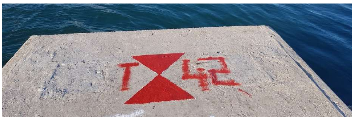
Target di appoggio per il rilievo aerofotogrammetrico materializzato a terra mediante pitturazione
