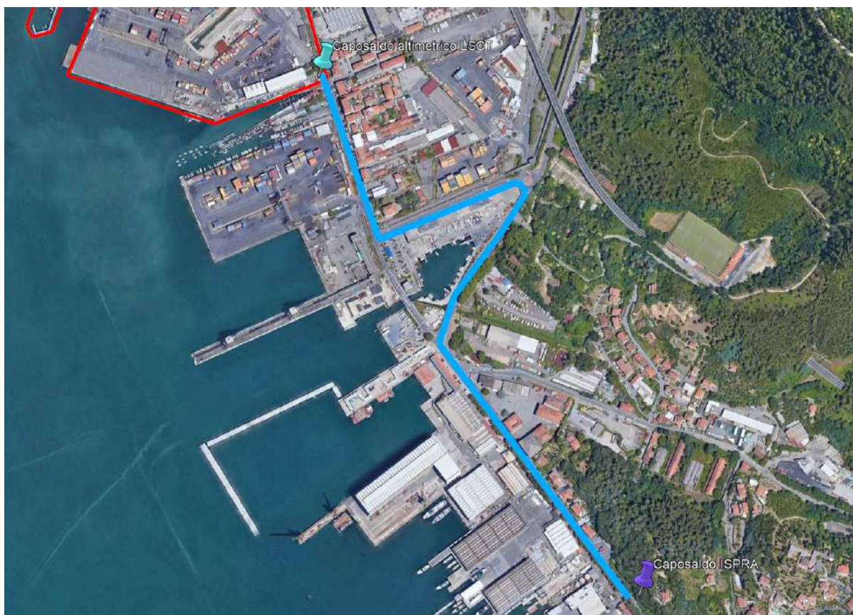
Linea di livellazione altimetrica (in colore blu), a partire dal caposaldo ISPRA (in colore viola) fino al caposaldo presso l'accesso al terminal Ravano (in colore ciano).
