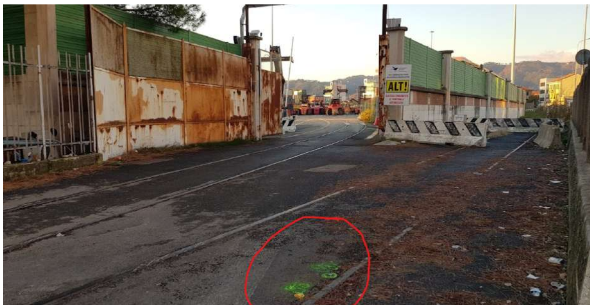
Chiodi/capisaldi altimetrici materializzati in area accessibile presso l'accesso Sud/Est del Terminal Ravano LSCT
