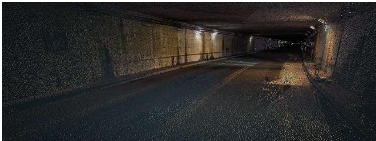
Nuvola di punti da laser scanner di parte della galleria Subalvea
