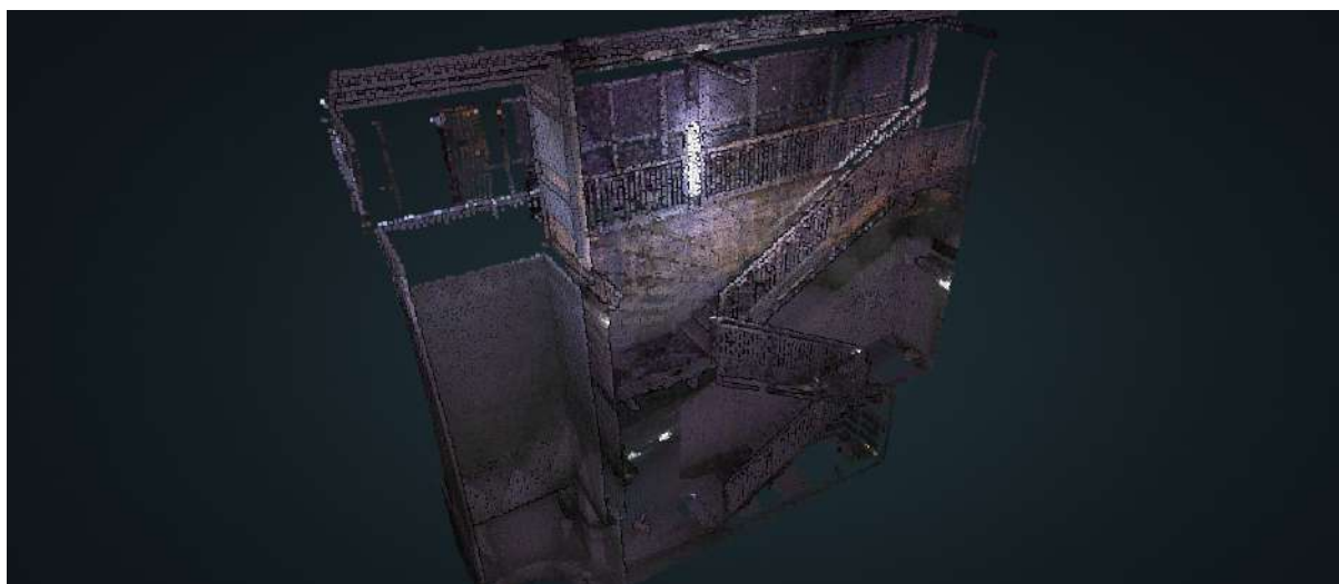
Nuvola di punti da laser scanner di parte dell'uscita di emergenza della galleria Subalvea lato Marina del Canaletto
