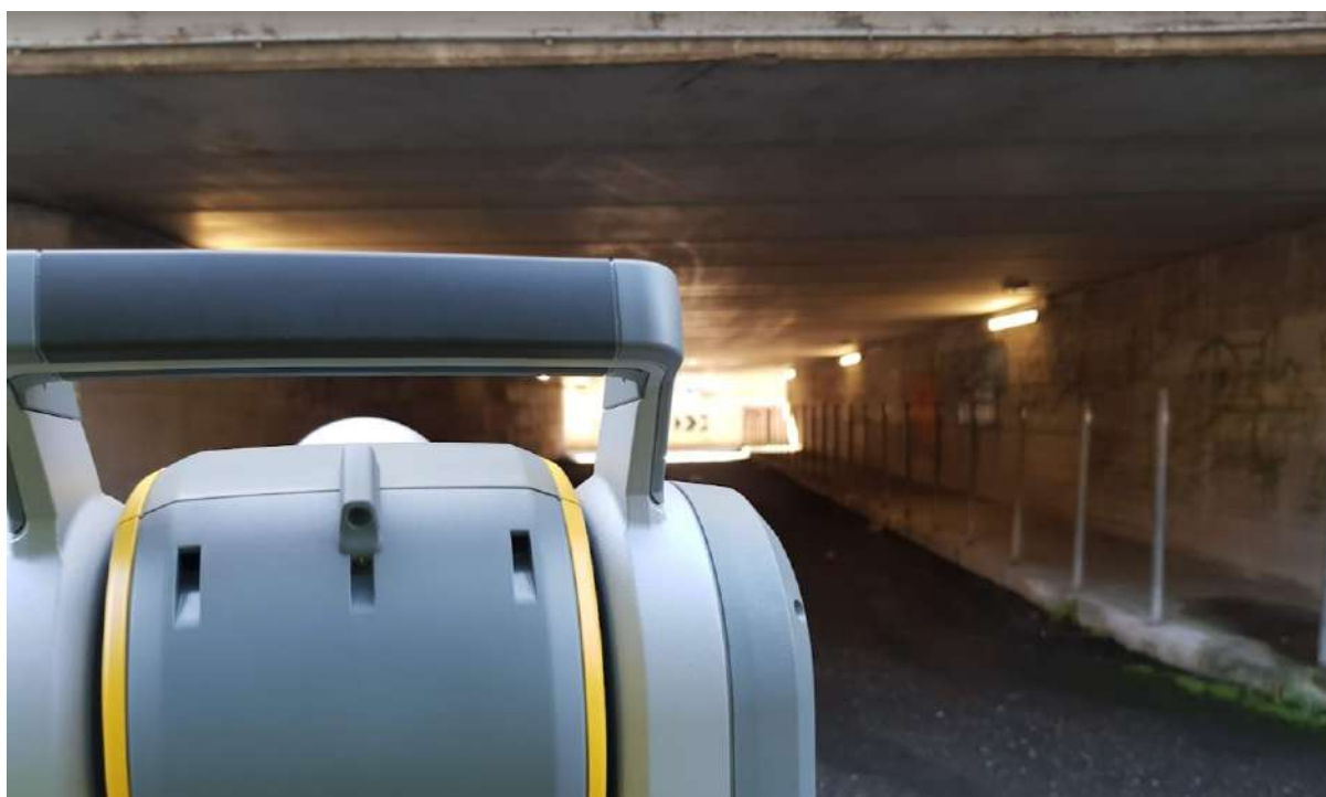
Rilievo laser scanner del sottopasso carrabile di accesso all'area della Marina del Canaletto
