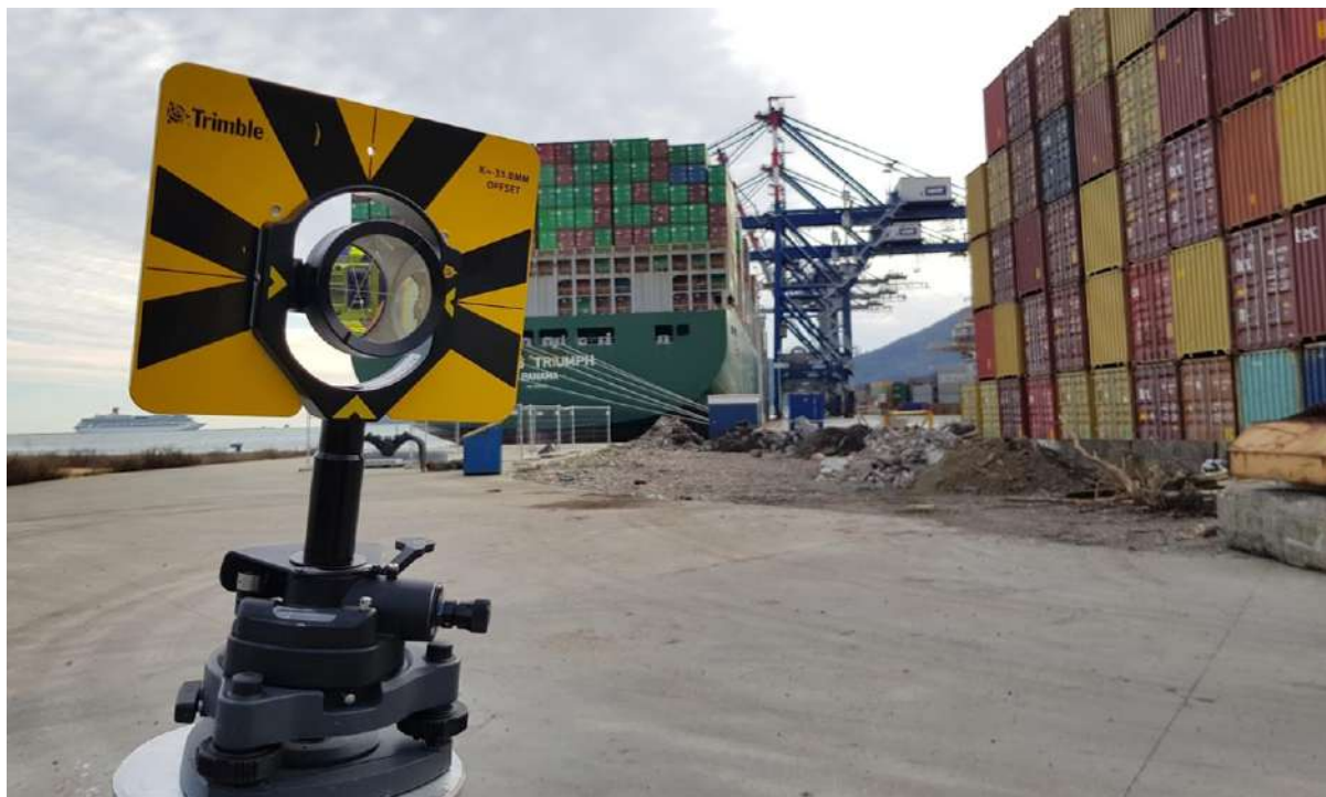
Prisma riflettente e centramento forzato impiegato durante le poligonali topografiche
