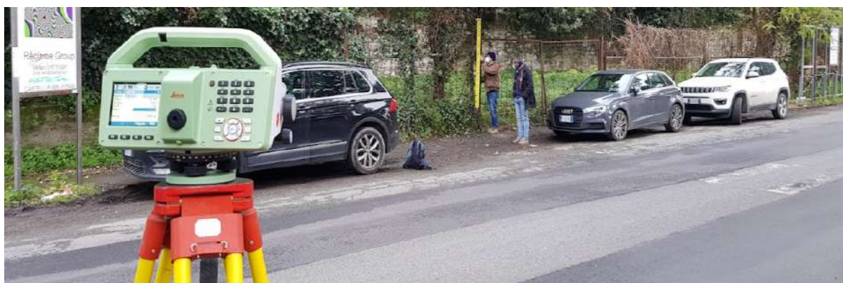
Operazioni di livellazione in corrispondenza del caposaldo ISPRA
