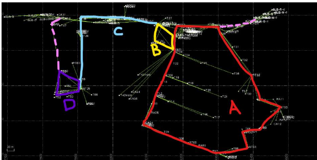
Misure in poligonale all'interno dell'area delle indagini
