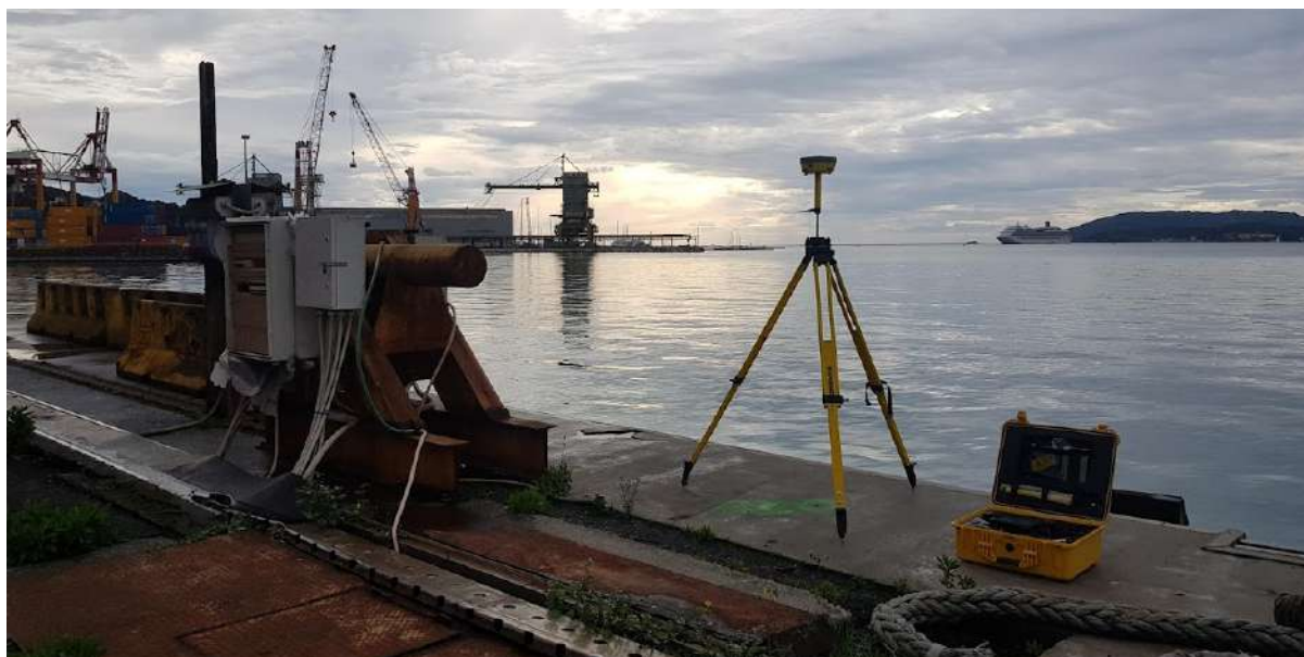
Rilievo GNSS statico della posizione planimetrica di un caposaldo della rete di inquadramento
