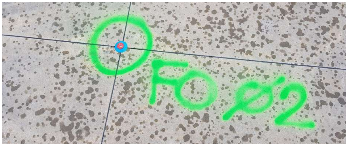
Caposaldo della rete di inquadramento, materializzato a terra mediante chiodo topografico
