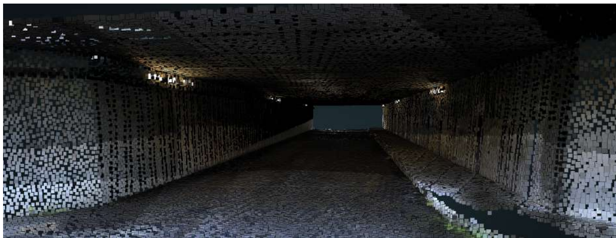
Nuvola di punti da laser scanner del sottopasso carrabile presso la Marina del Canaletto
