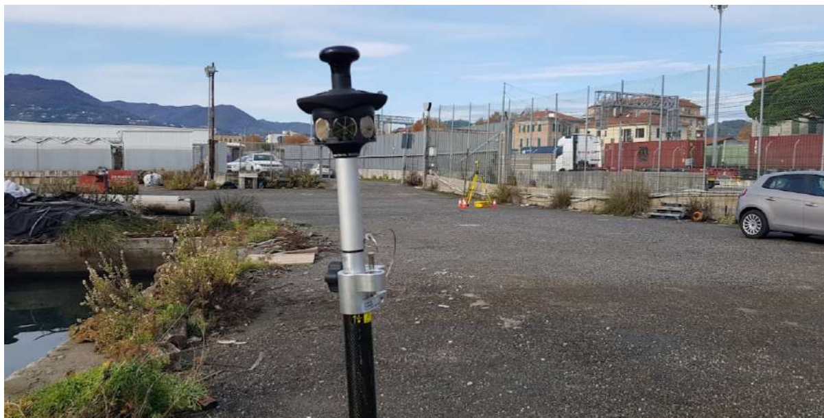
Prisma riflettente 360° montato su palina per la battuta di punti a terra e determinazione della quota
