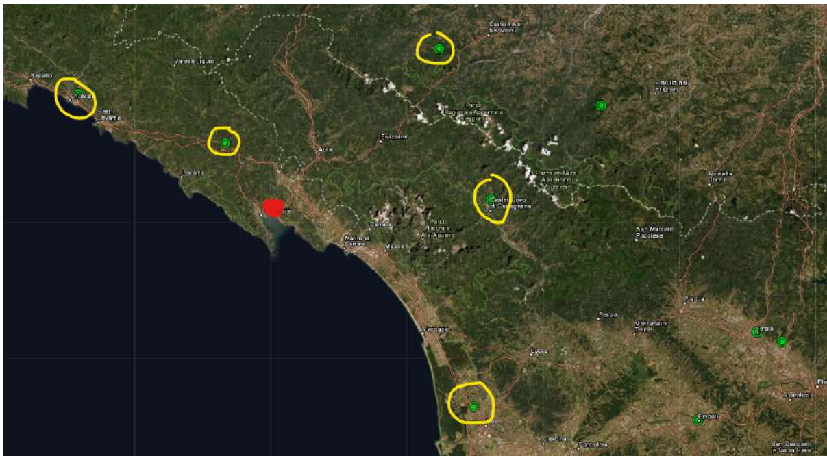
Posizione delle stazioni permanenti (in colore giallo) usate per il calcolo delle posizioni planimetriche dei capisaldi della rete all'interno dell'area di intervento (in colore rosso).
