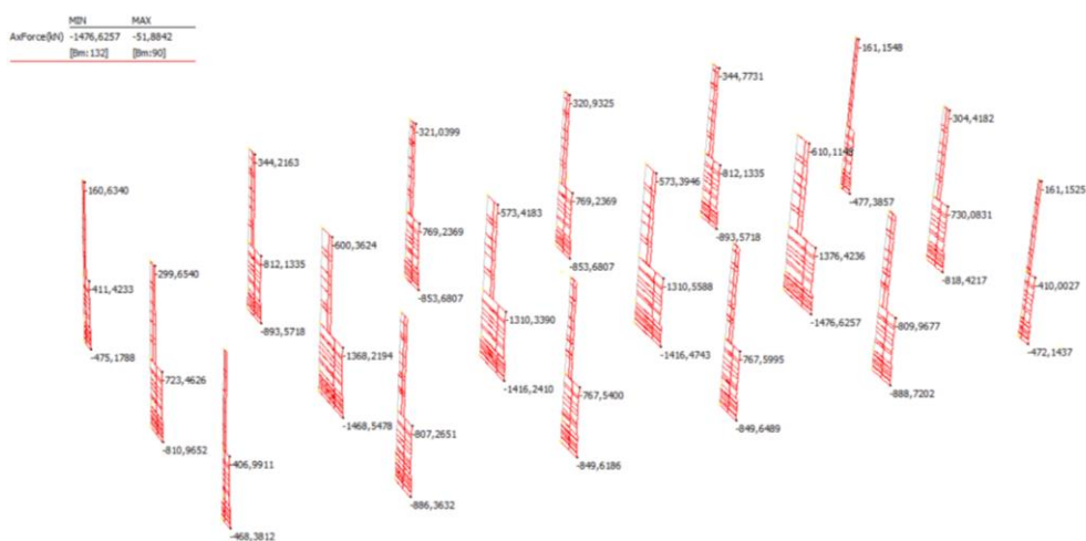
Figura 8-16: Sollecitazioni assiali massime sui pilastri: N_{Ed} = 1477 \text{ kN}
