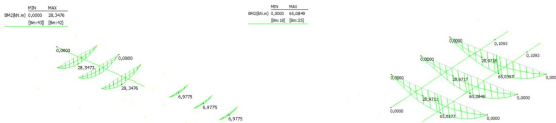
Figura 8-19: Sollecitazioni flessionali massime sulle travi HEA 160: M_{Ed} = 65 \text{ kNm}
