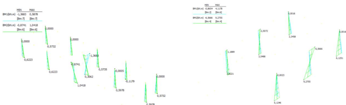
Figura 8-21: Sollecitazioni flessionali massime sulle colonne: M_{Ed}^x = 10 \text{ kNm} – M_{Ed}^y = 5 \text{ kNm}
