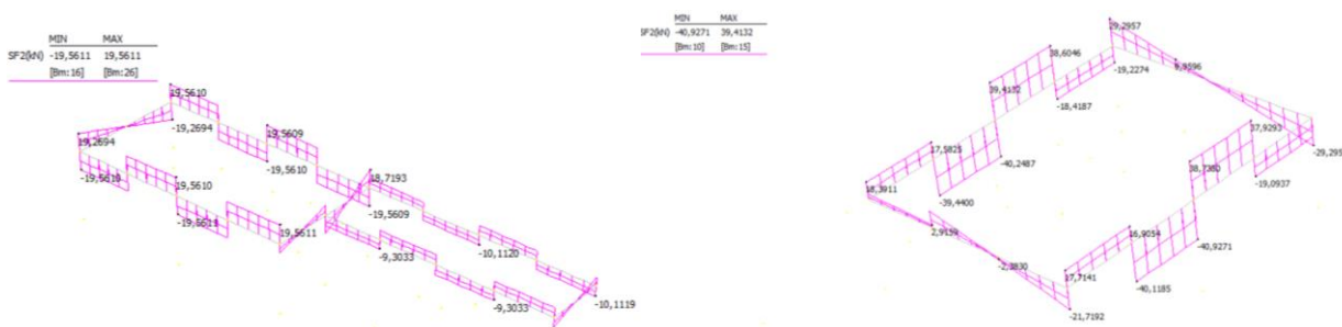
Figura 8-18: Sollecitazioni di taglio massime sulle travi HEA 200: V_{Ed} = 41 \text{ kN}
