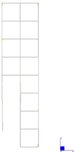
Figura 8-11: IV modo Rampa Ovest ( M_y = 63\% - T = 0.05 s)
