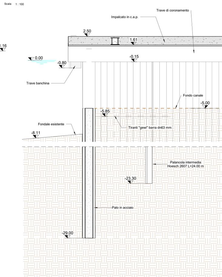
**Sezione 14 - Sezione banchina**
