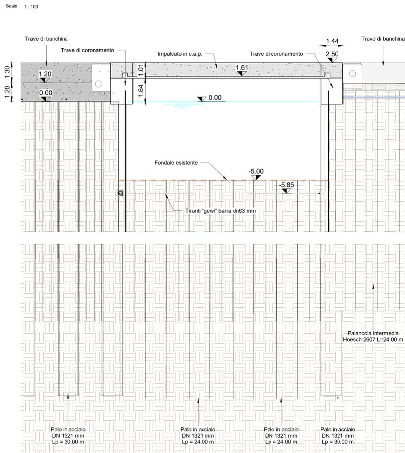
**Sezione 13 Sezione longitudinale torrente Vecchia Dorgia**
