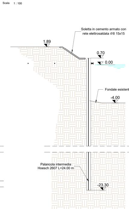
**Sezione 11 - Sezione tipo banchina Fornelli**
