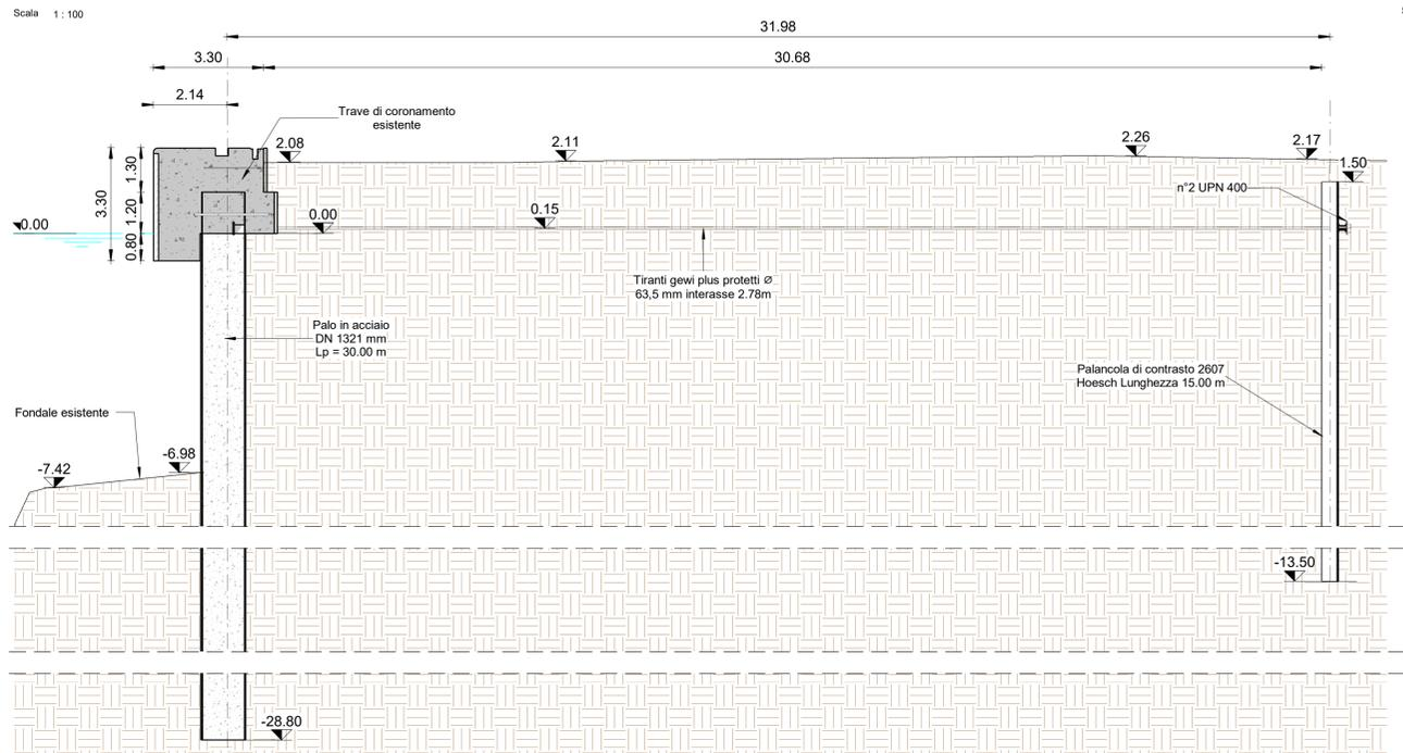
**Sezione 10 - Sezione tipo banchina Fornelli**
