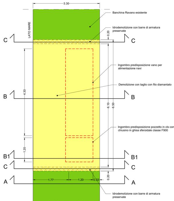
PLANIMETRA DI DETTAGLIO DEMOLIZIONI TRAVE ESISTENTE
