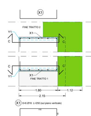
SEZIONE C-C DETTAGLIO ARMATURA
