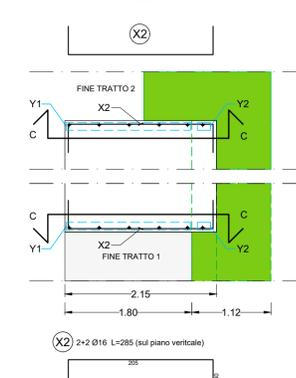
PIANTA B-B DETTAGLIO ARMATURA
