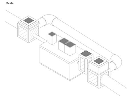
**Prospetto tipologico impianto di trattamento in continuo delle acque di prima pioggia**
