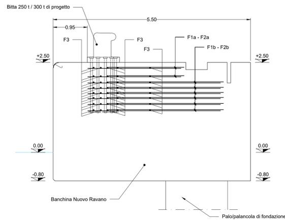
ARMATURA DI FRETTAGGIO BITTA E ARMATURA TRAVE
