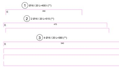
ARMATURA DI FRETTAGGIO BITTA
