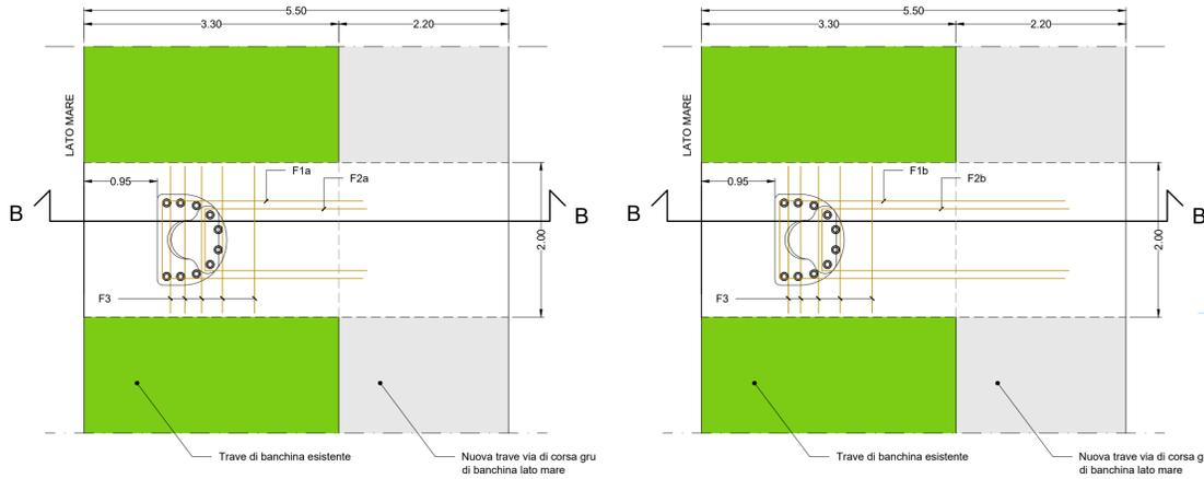
ARMATURA DI FRETTAGGIO BITTA
