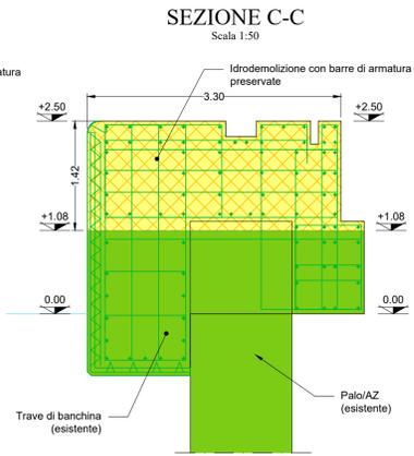
PLANIMETRA DI DETTAGLIO DEMOLIZIONI TRAVE ESISTENTE
