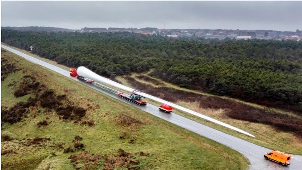
Figure 13 – Trasporto sezione pala
