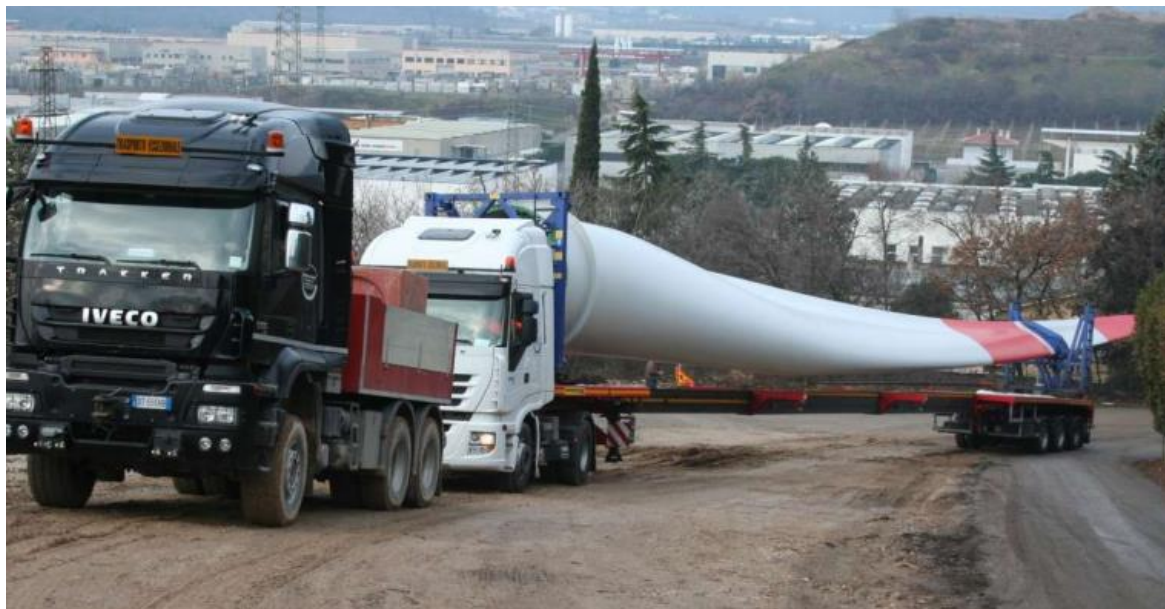
Figure 8 - Esempio di traino durante il cantiere
