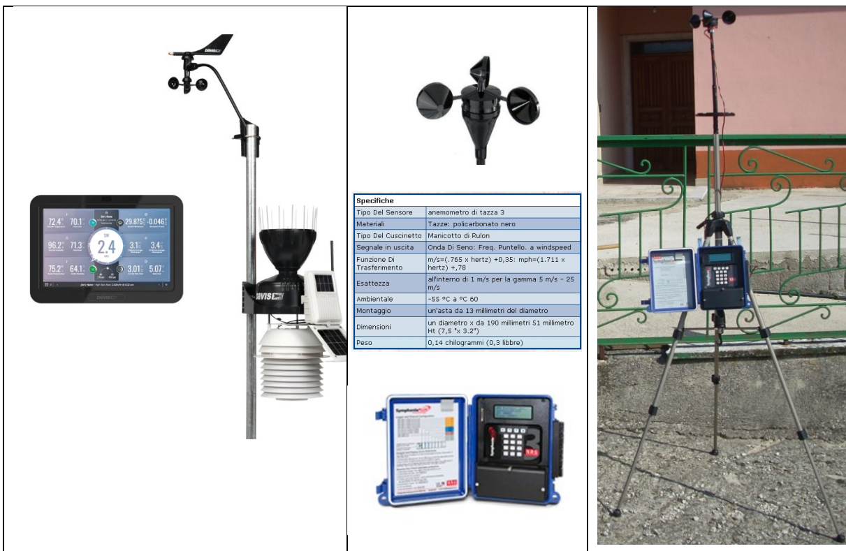
Figura 2: Stazione meteo portatile utilizzata- l'altezza di misura dei sensori è 1,5 m; Specifiche tecniche dell'NRG #40 Maximum caratteristiche tecniche DATA LOGGER
