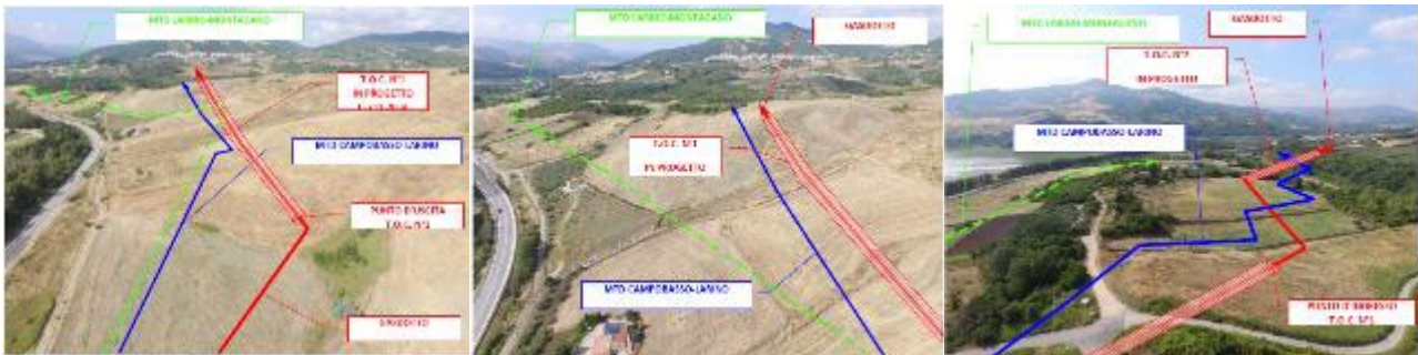
Figura 5 Superamento area a franosità diffusa (TOC n.1) – Strada Vicinale del Molino Palata – Strada Vicinale Vallocchia Ischia del Ponte
