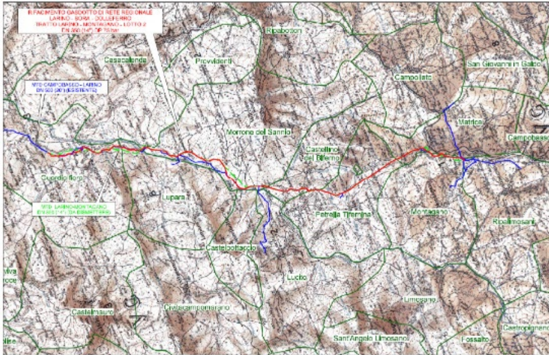
Figura 2 Inquadramento generale delle opere in progetto identificate nello stralcio in colore rosso mentre in verde viene indicato il gasdotto da dismettere e porre fuori esercizio, in blu il gasdotto esistente SGI (cfr. Elab. 5733-1-001-PG-D-1000)
