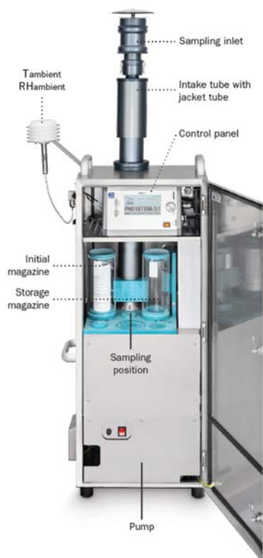
Figura 36 - Campionatore sequenziale automatico
