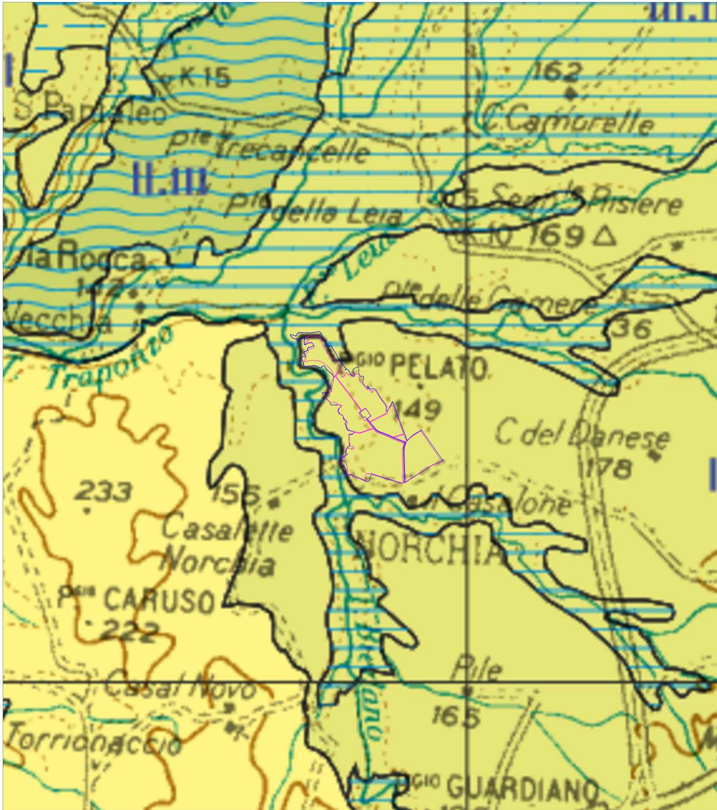
PERIMETRO IMPIANTO AGRO-FOTOVOLTAICO IN PROGETTO (INVILUPPO TELAI DI SOSTEGNO DEI PANNELLI)
