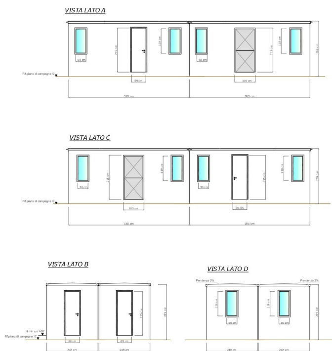
Illustrazione 38: Prospetto Tipologico Control Room
