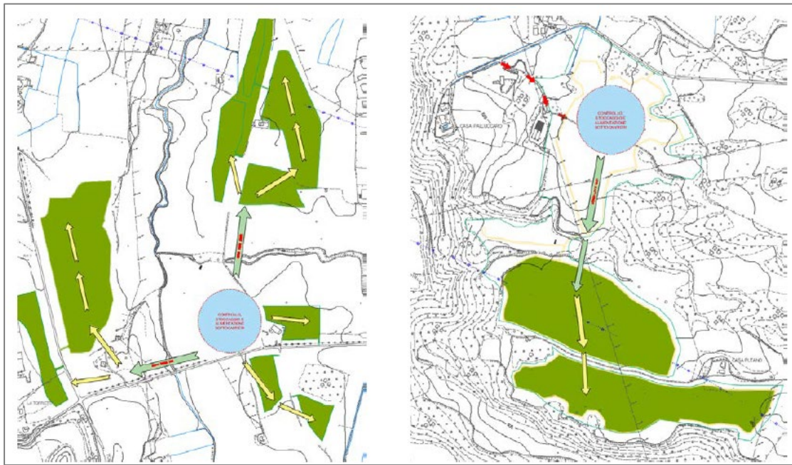
Figura 6 – Schema concettuale dislocazione cantieri e alimentazione sottocantieri
