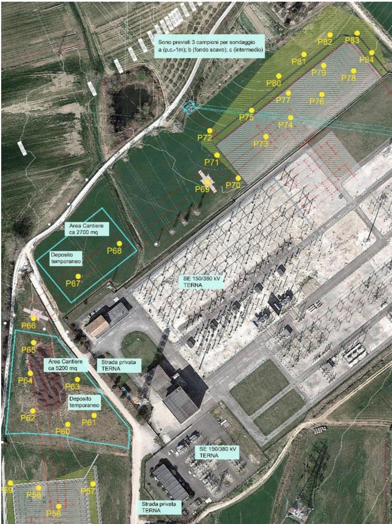
Figura 108: Punti di sondaggio delle terre e rocce da scavo previsti nell'area della linea aerea e dello Stallo 380 kV
