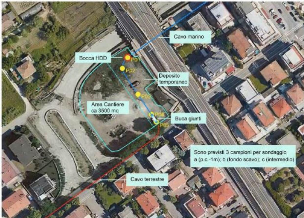
Figura 106: Planimetria dell'area HDD e buca giunti, con indicazione dei punti di sondaggi previsti.
