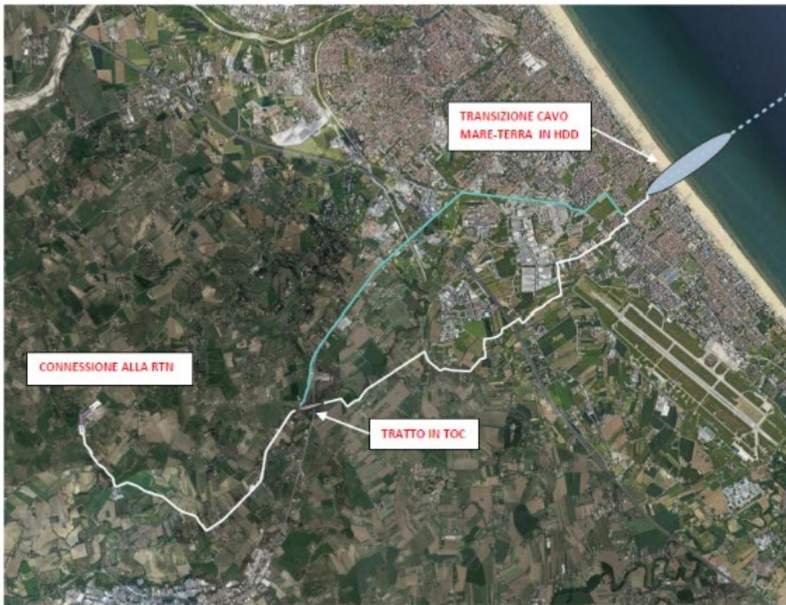
Figura 22: Opere terrestri di collegamento della Centrale Eolica Offshore alla RTN
