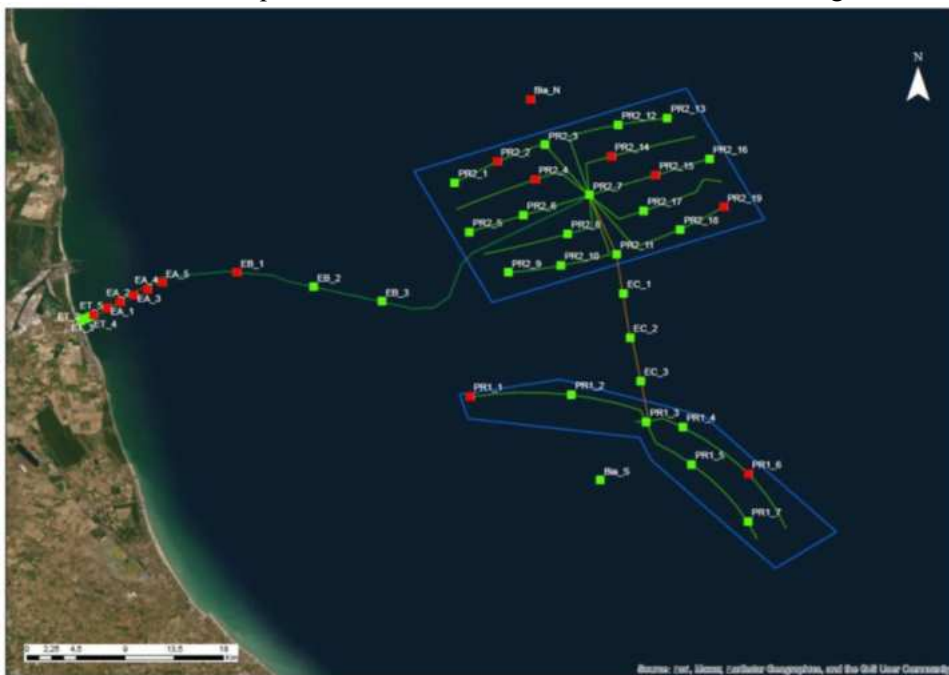
Figura 95: Rappresentazione grafica delle stazioni con superamenti nei livelli chimici ed effetti tossici sugli organismi test, evidenziati dai quadrati rossi.
