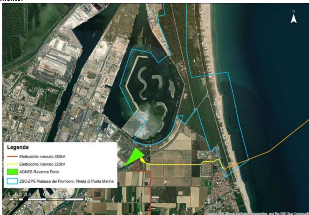
Figura 160: Dettaglio dell'attraversamento dell'elettrodotto interrato nella parte meridionale del ZSC-ZPS IT4070006 - "Pialassa dei Piomboni, Pineta di Punta Marina"
