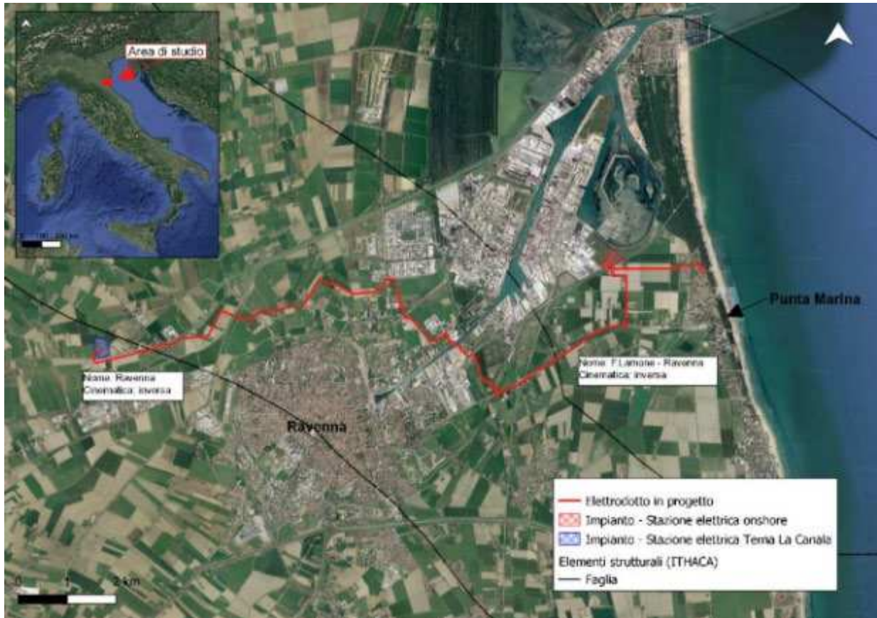
Figura 139 - Interferenza tra il tracciato in progetto e le faglie attive e capaci del catalogo ITHACA
