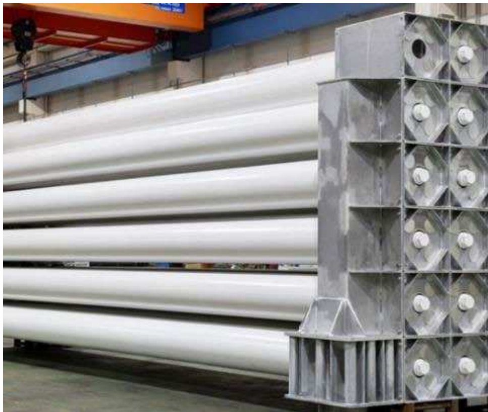
Figura 32: Tipologia di stoccaggio tramite tube trailer
