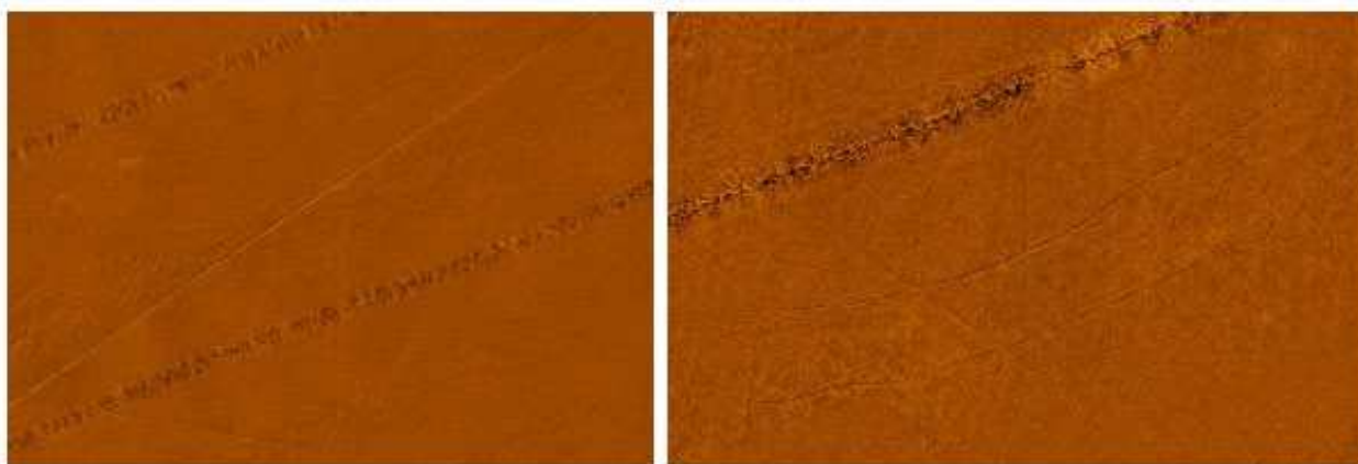
Figura 133: Condotta poggiata sul fondo rilevata nel parco "Romagna 2" (a sinistra) ed esempio di solchi riconducibili all'attività di pesca a strascico (a destra)
