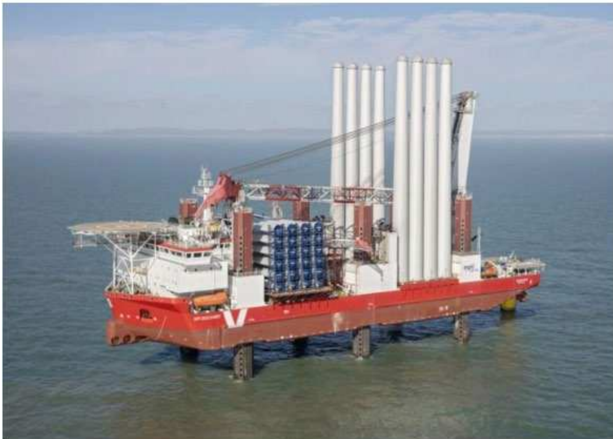
Figura 43: Nave carica con componenti degli aerogeneratori
