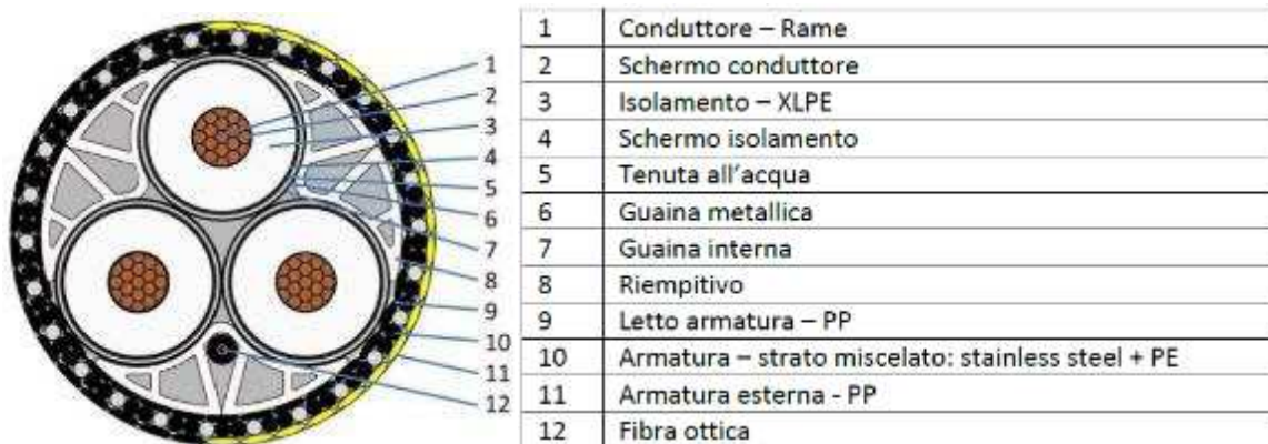
Figura 16: Stratigrafia cavo dinamico 220 kV in CA
