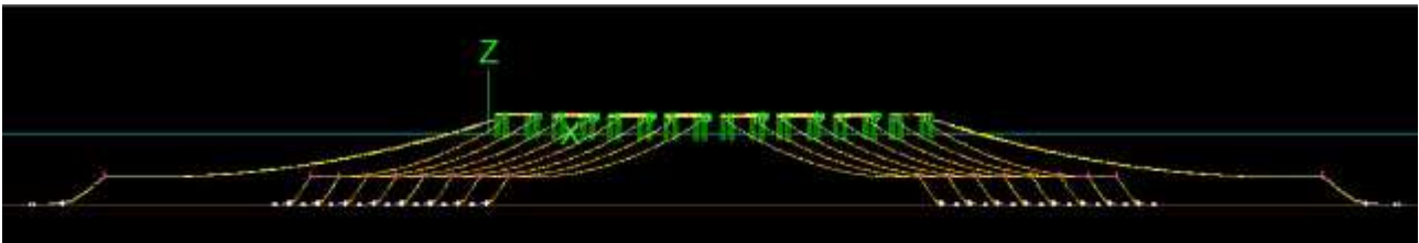
Figura 8: Sistema di ormeggio e ancoraggio (immagine di Solar Duck)
