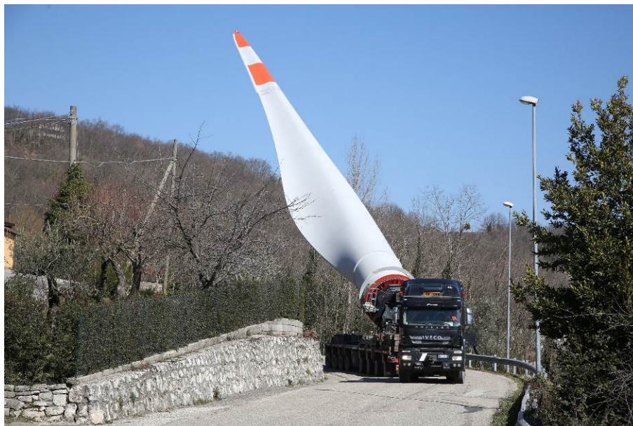
Esempio di un mezzo semovente, trainato da trattore stradale, con pala inclinata.
