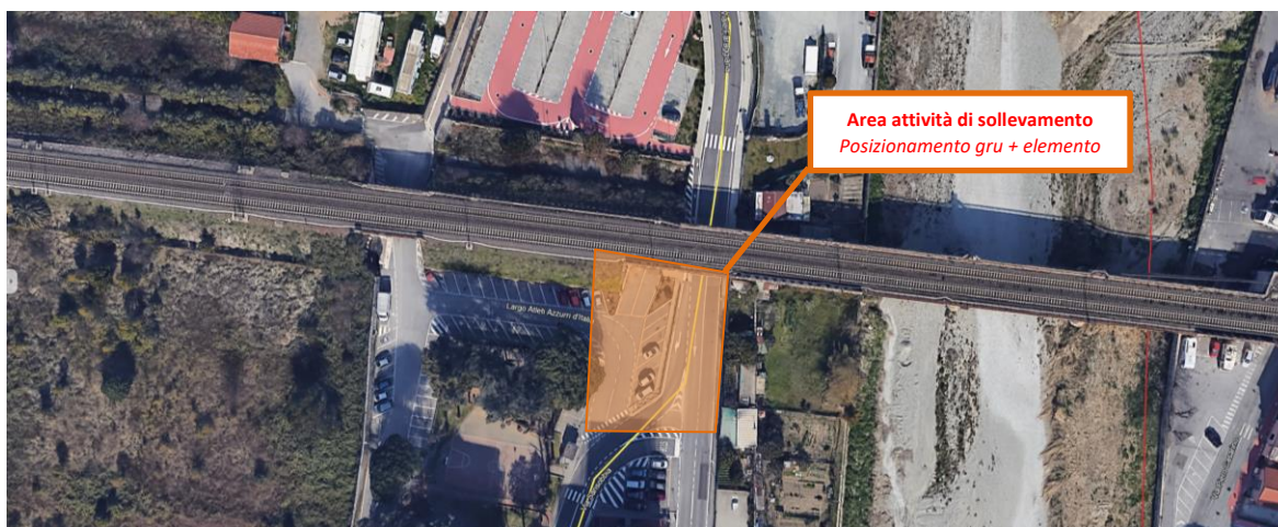
Figura 11 – Area allestimento gru e attività di sormontamento attraversamento ferroviario
