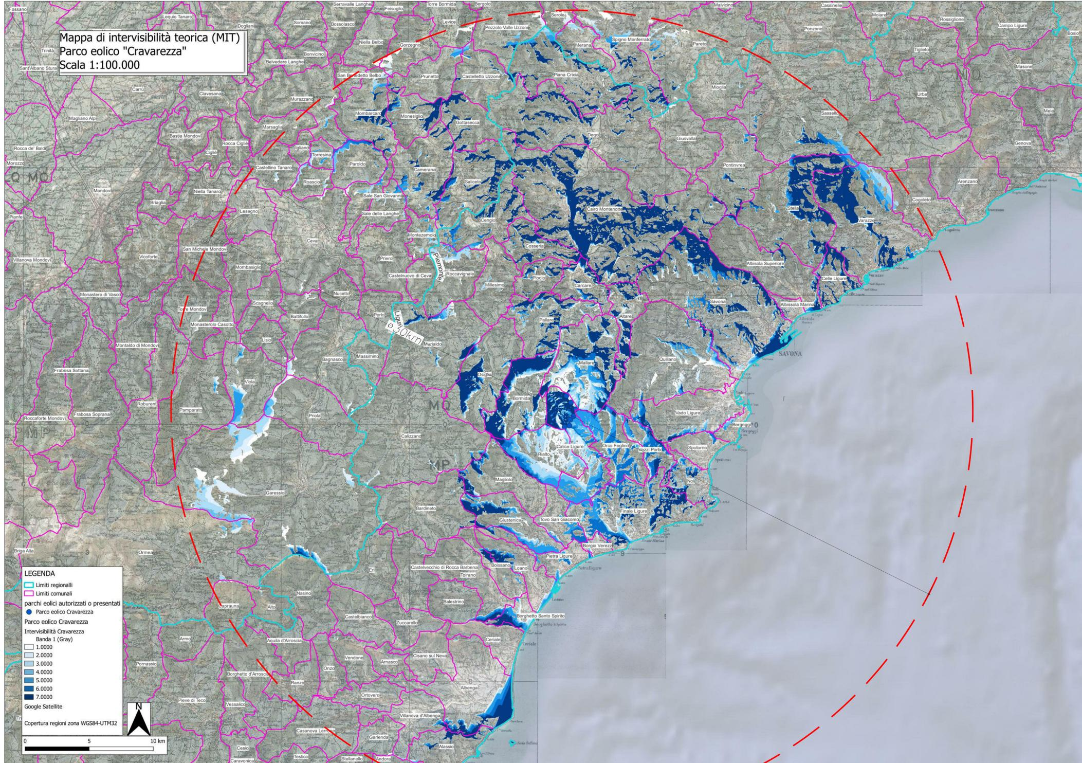
N.B.: il presente parco eolico in progetto consiste nell'ampliamento con revamping del parco eolico "Pian dei Corsi" di Calice Ligure. Verranno quindi smantellate le 3 turbine esistenti e sostituite ed aumentate in numero da 3 a 7
