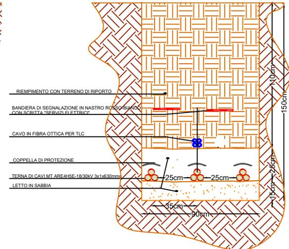
PARTICOLARI SEZIONI DI SCAVO A TRINCEA PER ELETTRODOTTI INTERRATI SU TERRENO E SU STRADA O PIAZZOLA (SCALA 1:20)
