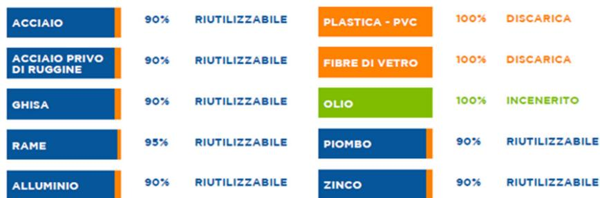
Figura 26 Grado di riutilizzabilità dei componenti di una turbina (ANEV 2023)
