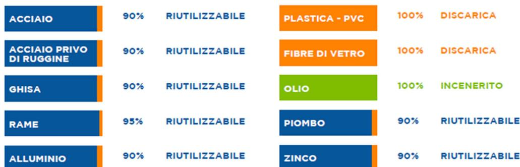
Figura 19 Riciclabilità delle componenti di un aerogeneratore; fonte: ANEV 2023
