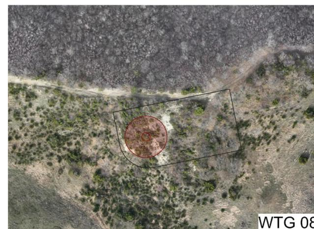
Figura 12 Dall'alto in basso e da sinistra a destra: ortofoto da drone dei siti delle WTG da 05 a 08; il rettangolo nero indica l'ingombro dei piazzali di esercizio; in rosso la piastra di fondazione delle turbine (dimensioni orientative)
