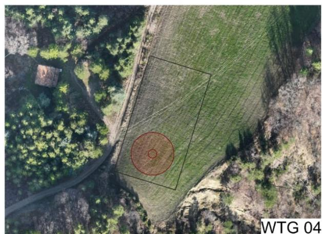
Figura 11 Dall'alto in basso e da sinistra a destra: ortofoto da drone del sito della SSE utente, immagine satellitare del sito della Cabina primaria esistente (Google Earth), ortofoto da drone dei siti delle WTG da 01 a 04; il rettangolo nero indica l'ingombro dei piazzali di esercizio; in rosso la piastra di fondazione delle turbine (dimensioni orientative)
