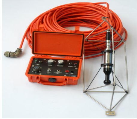
Figura 4. Registratore acustico COL.MAR con idrofono SMID GP1280 usato per misurare il rumore sottomarino presso l'FSRU Toscana.
