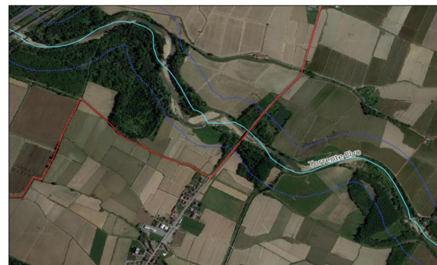
**Figura 3.** Rappresentazione del tracciato del cavidotto di connessione in corrispondenza dell'attraversamento sul torrente Elvo.
