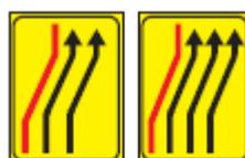
Da utilizzare per indicare la deviazione in parallelo, su corsie adiacenti, per la presenza di una deviazione in corrispondenza di un cantiere stradale, la deviazione può anche interessare la sola corsia di emergenza.
