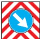
Segnale di cui devono essere dotati posteriormente i veicoli operativi, i macchinari ed i mezzi d'opera impiegati per lavori o manutenzione stradale, fermi o in movimento. La freccia è orientata dal lato dove il veicolo deve essere superato
