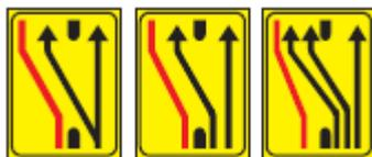
Da utilizzare per indicare la possibilità di proseguire dritto o su una o su due delle corsie della carreggiata opposta, per la presenza di una deviazione in corrispondenza di un cantiere stradale.
