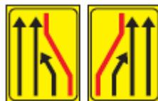
Da utilizzare per indicare la riduzione da tre a due corsie di marcia per la presenza di una deviazione in corrispondenza di un cantiere stradale.
