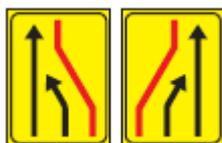
Da utilizzare per indicare la riduzione da due ad una corsia di marcia per la presenza di una deviazione in corrispondenza di un cantiere stradale.
