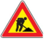
Installato nei pressi di cantieri fissi o mobili, anche se di manutenzione, integrato con un pannello indicante l'estensione del cantiere, quando il tratto di strada interessato sia più lungo di 100 metri, ed eventualmente abbinato ad un dispositivo luminoso a luce rossa fissa.
