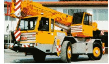
In funzione del tipo di lavoro è necessario, in alcuni casi, procedere alla stabilizzazione della macchina e lavorare con braccio che ruota, mentre in altri casi l'autogrù deve muoversi continuamente per prelevare o depositare i materiali nel loro giusto posto
