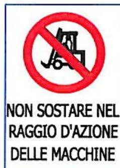
INFORMAZIONE E FORMAZIONE DEI LAVORATORI CIRCA LA NATURA DEI RISCHI, IL DIVIETO DI TRANSITARE E SOSTARE NEL RAGGIO D'AZIONE DELL'ESCAVATORE DOTATO DI MARTELLO DEMOLITORE E L'OBBLIGO DI INDOSSARE I D.P.I. (INDUMENTI AD ALTA VISIBILITÀ, OTOPROTETTORI, CASCO, SCARPE ANTINFORTUNISTICHE ED OCCHIALI DI PROTEZIONE DAL RISCHIO DI PROIEZIONE DI SCHEGGE).
