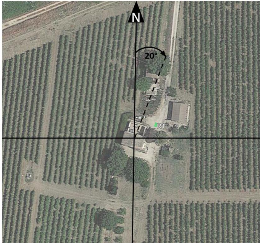
Figura 3-5 Esempio di identificazione dell'orientamento delle finestre dei ricettori
