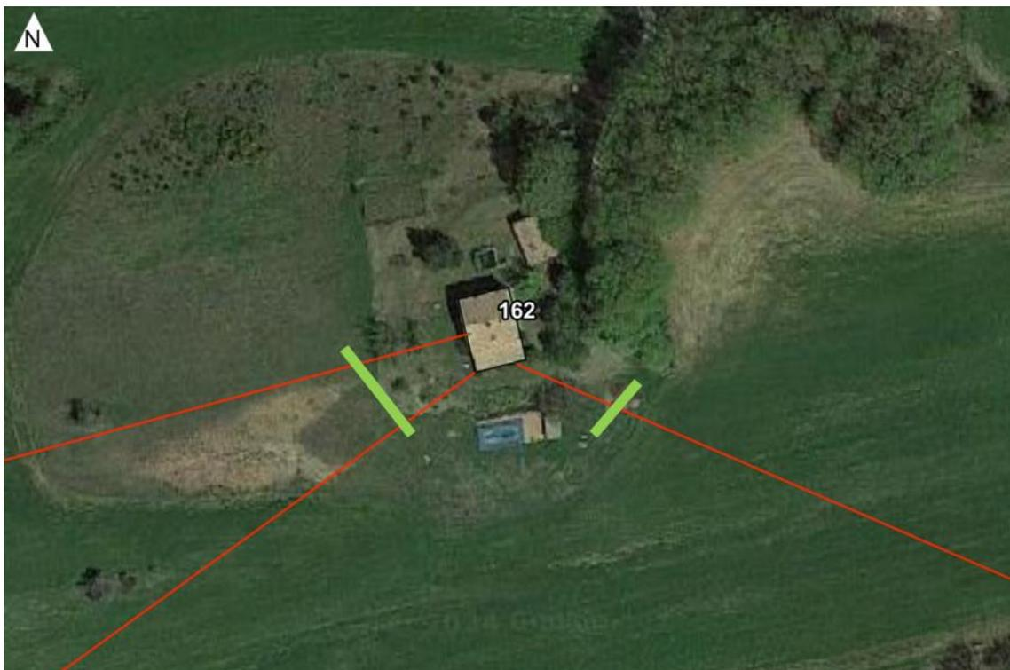
*Figura 3-28 Lato del ricettore esposto al fenomeno di shadow flickering con opera di mitigazione*
