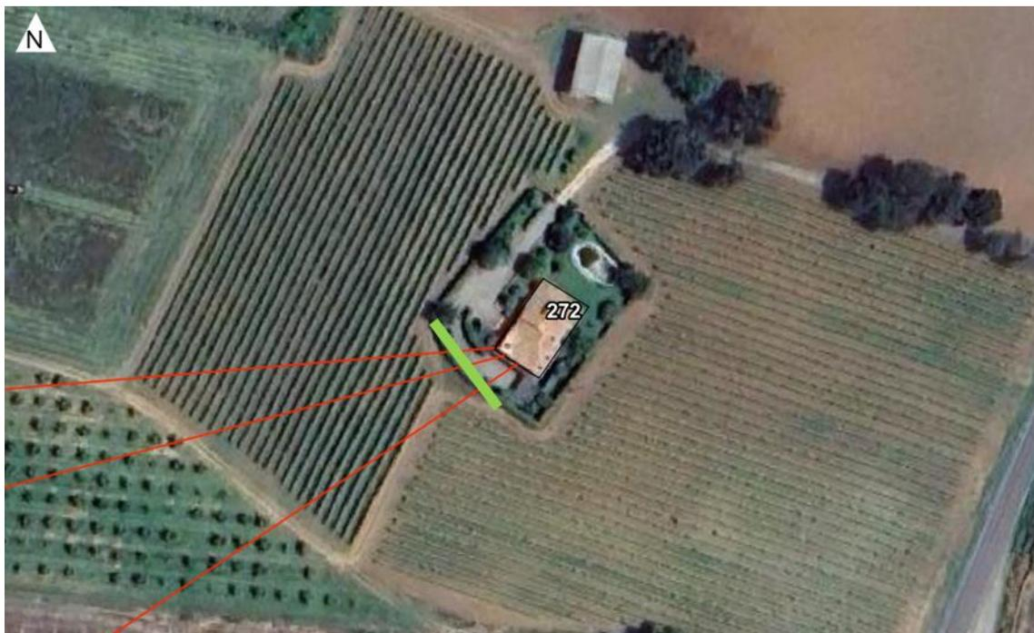
Figura 3-50 Lato del ricettore esposto al fenomeno di shadow flickering con opera di mitigazione
