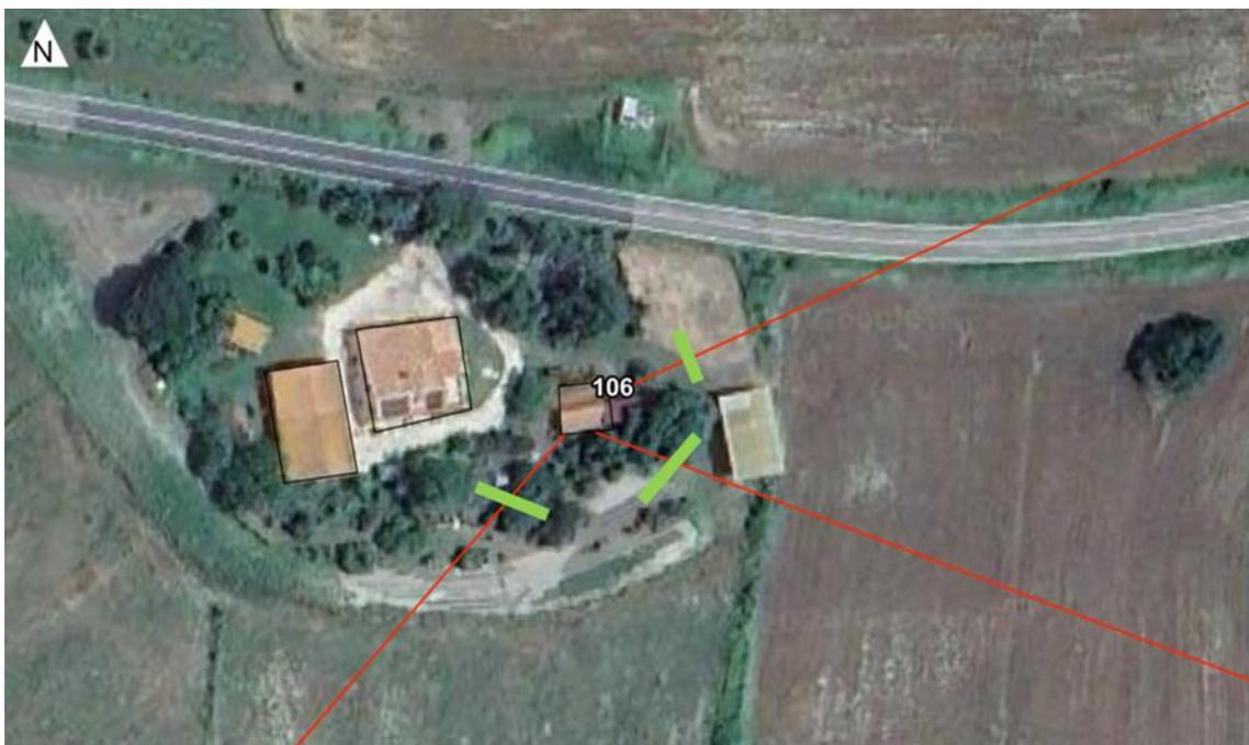
Figura 3-25 Lato del ricevitore esposto al fenomeno di shadow flickering con opera di mitigazione
