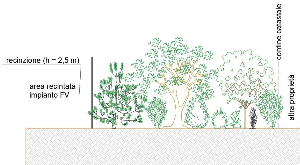
Figura 4. – Stralcio sezione della siepe (area perimetrale dell'impianto)
