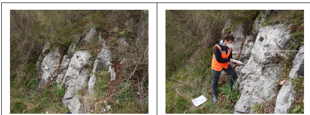
Fig. 1 Linea di rilievo e misura della resistenza alla compressione con sclerometro
