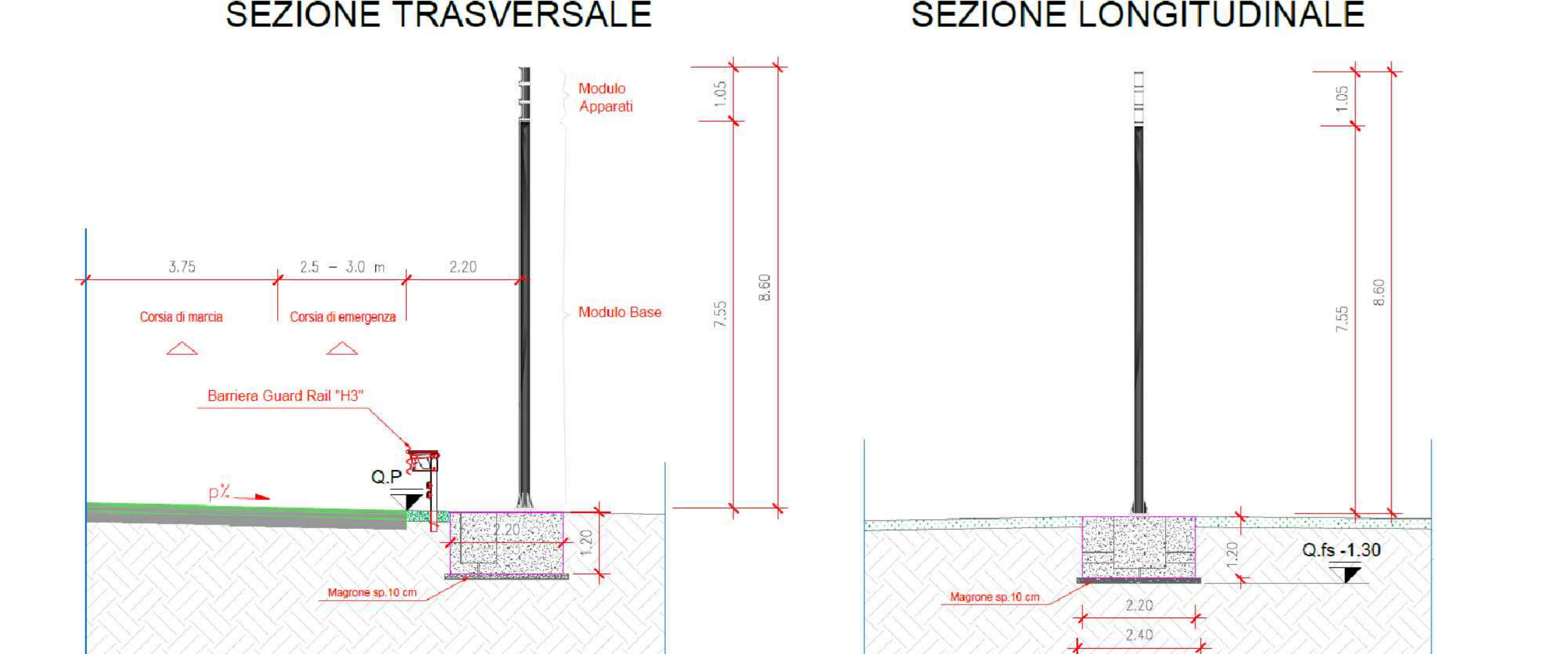
TIPOLOGICO PLINTO SU TERRENO PIANEGGIANTE
