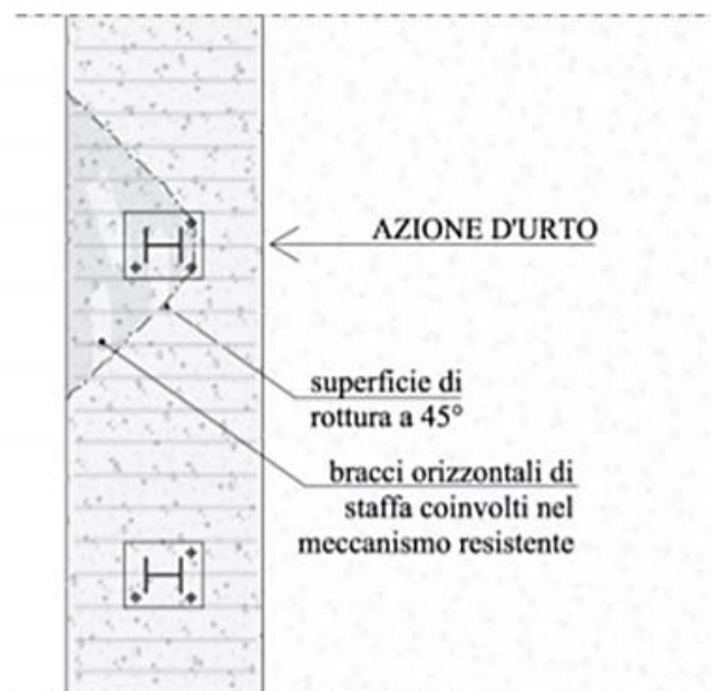
Cono di diffusione verifica staffe orizzontali
