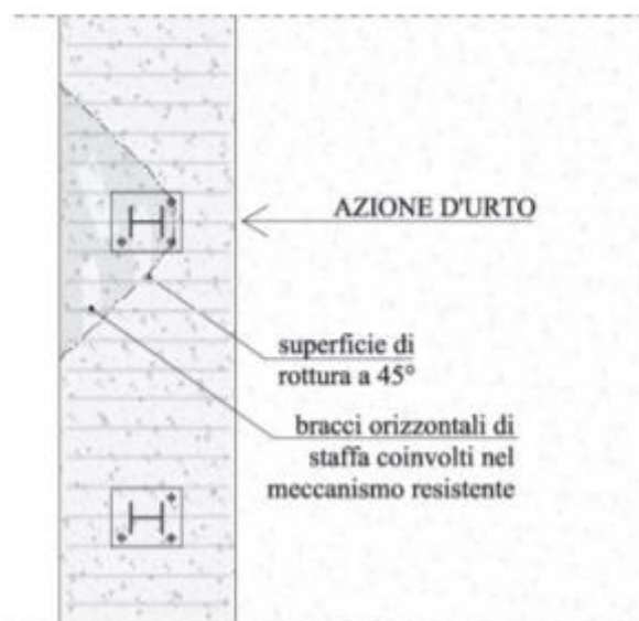
Figura 21: cono di diffusione verifica staffe orizzontali
