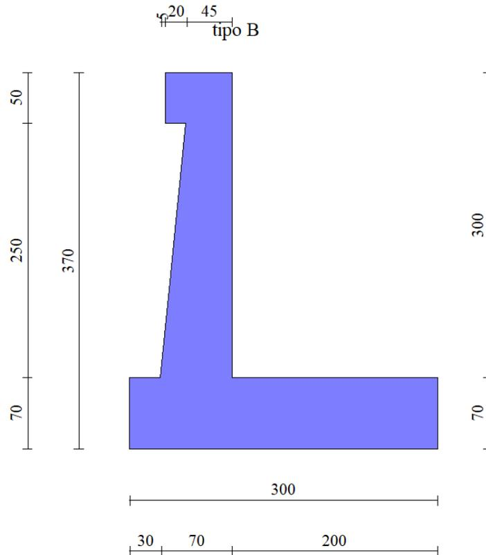
Figura 28: Geometria del muro di sostegno: sezione trasversale
