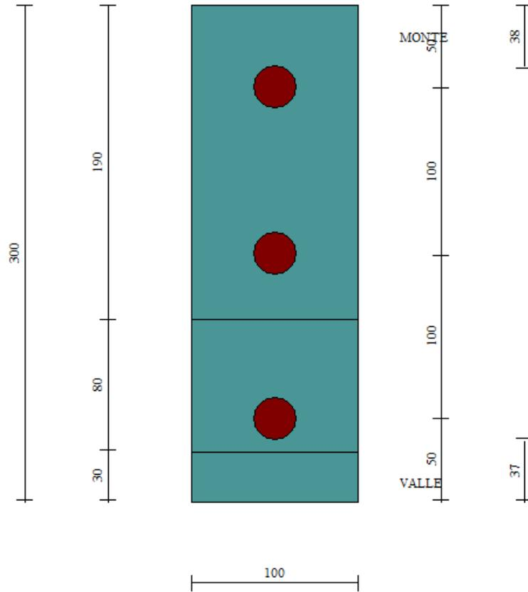
**Figura 38:pianta fondazione su pali**
