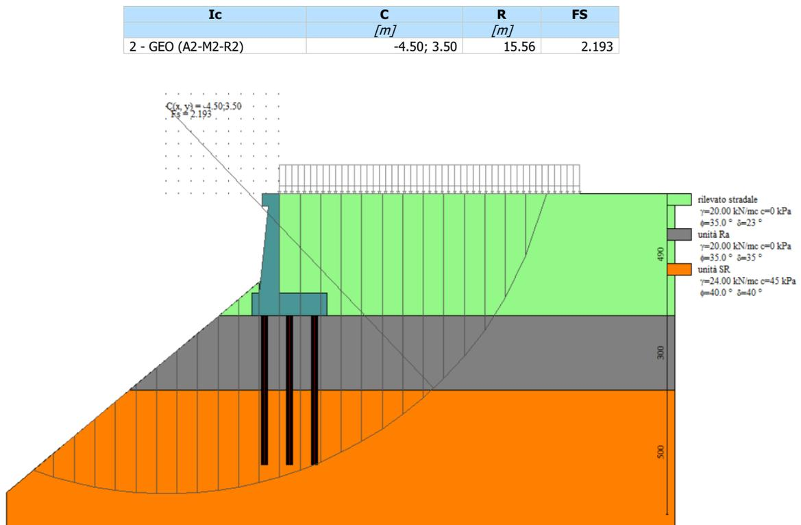
Figura 42: Verifica di stabilità globale\_ cond. statica\_FS=2.87
