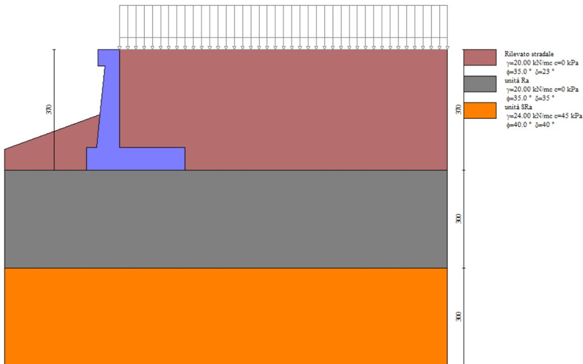
Figura 27: modello di calcolo muro tipologico B
