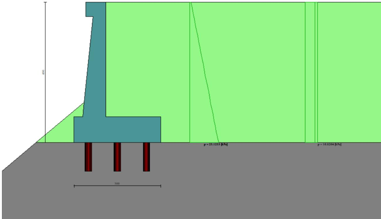
Figura 44: Inviluppo spinte \_combinazione sismica H+V
