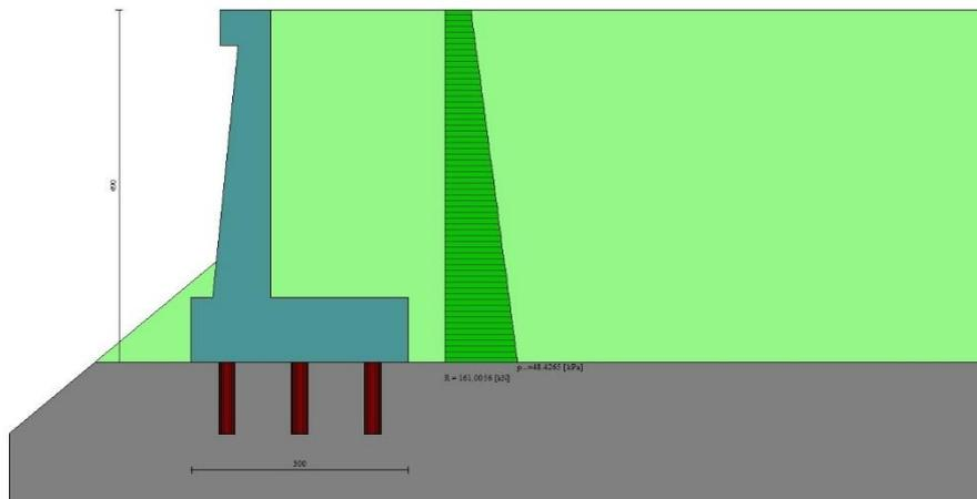
Fig. 5 - Diagramma delle pressioni (combinazione statica) (Combinazione n° 1)
