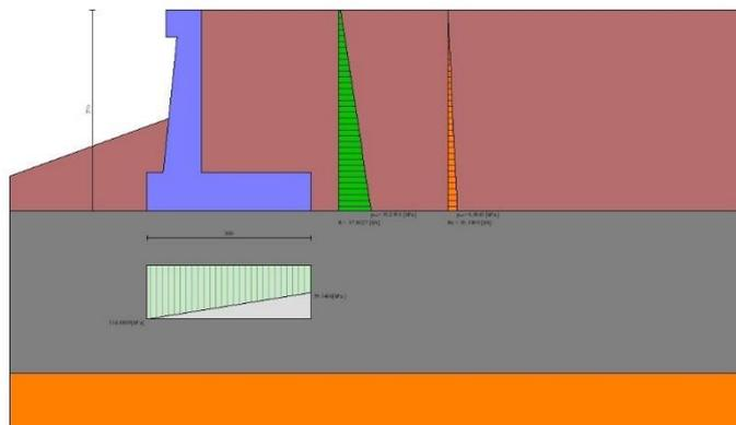
Fig. 6 - Diagramma delle pressioni (combinazione sismica) (Combinazione n° 2)
