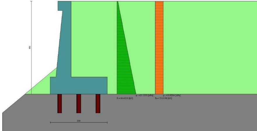
Fig. 5 - Diagramma delle pressioni (combinazione statica) (Combinazione n° 1)
