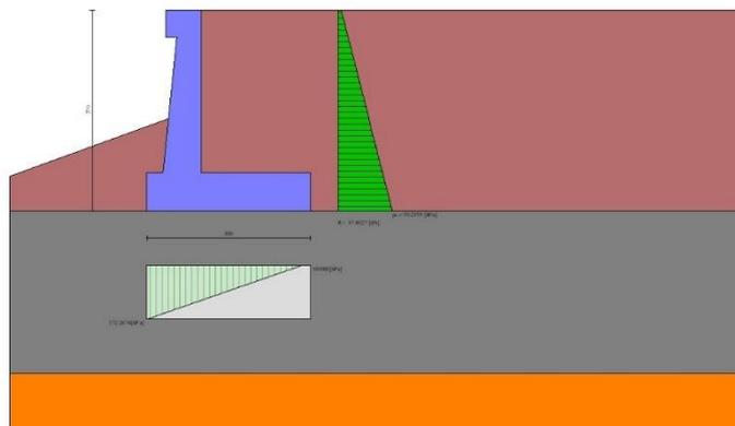
Fig. 10 - Diagramma delle pressioni (combinazione statica) (Combinazione n° 1)
