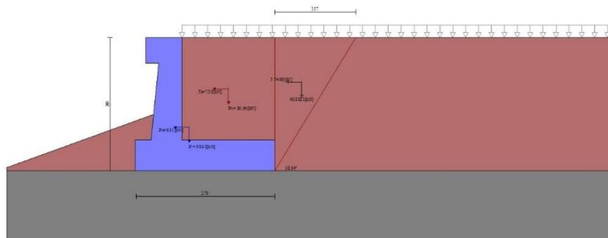
Fig. 13 - Cuneo di spinta (combinazione sismica) (Combinazione n° 2)
