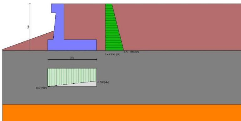
Fig. 12 - Diagramma delle pressioni (combinazione statica) (Combinazione n° 1)
