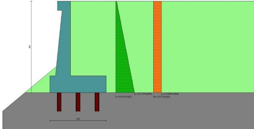
Fig. 22 - Diagramma delle pressioni (combinazione statica) (Combinazione n° 1)
