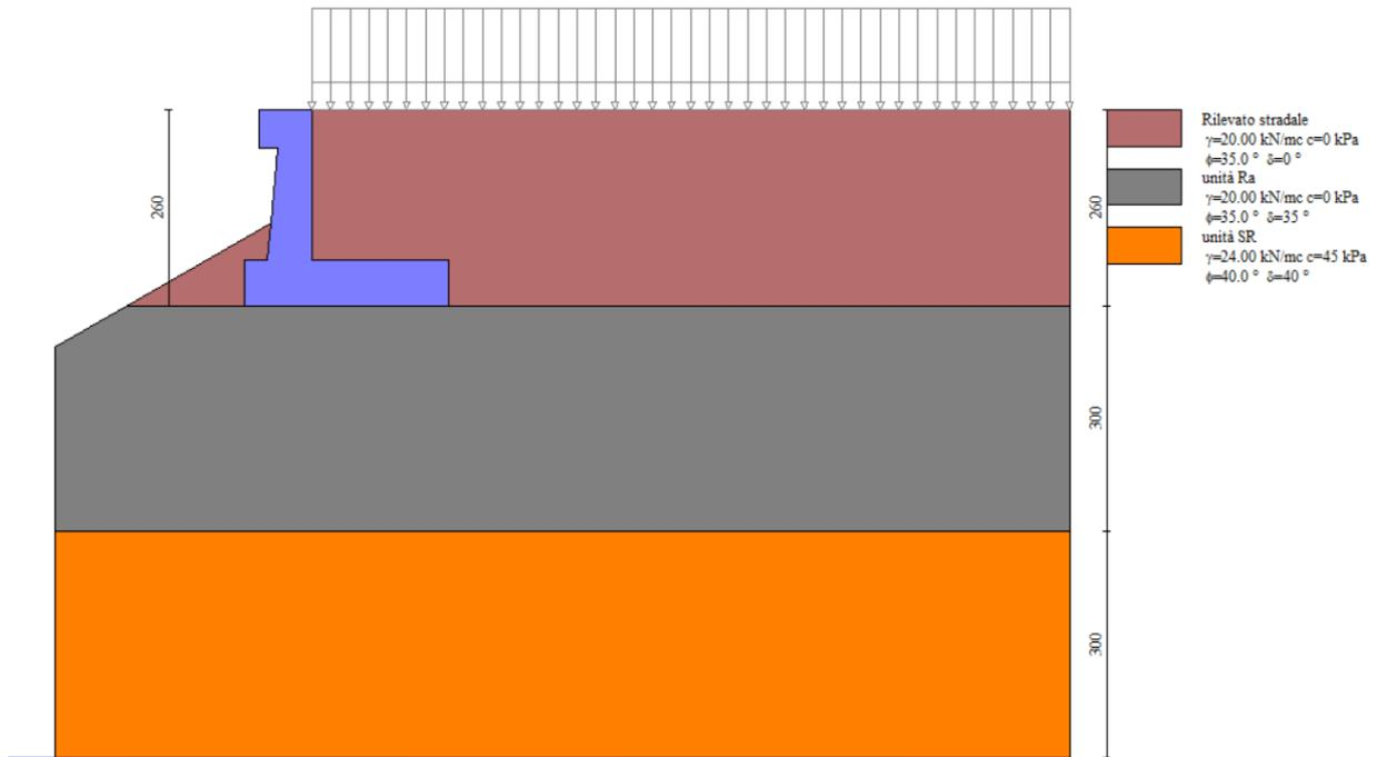
Figura 18: modello di calcolo muro tipologico A
