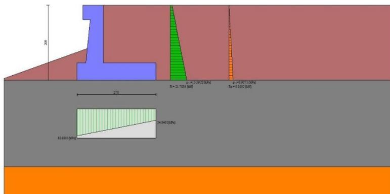
Fig. 14 - Diagramma delle pressioni (combinazione sismica) (Combinazione n° 2)
