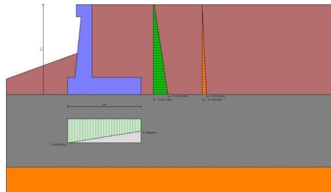
Fig. 14 - Diagramma delle pressioni (combinazione sismica) (Combinazione n° 2)
