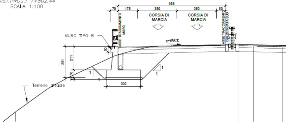
Figura 4: sezione trasversale muro tipologico B
