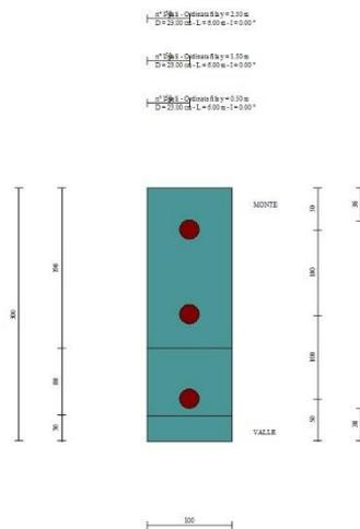
Fig. 2 - Pianta pali
