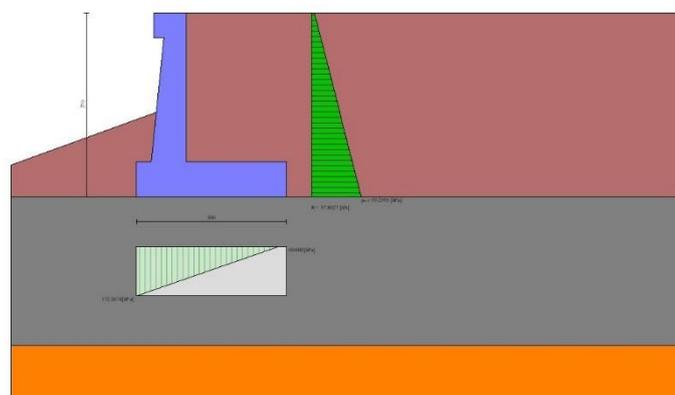
Fig. 4 - Diagramma delle pressioni (combinazione statica) (Combinazione n° 1)
