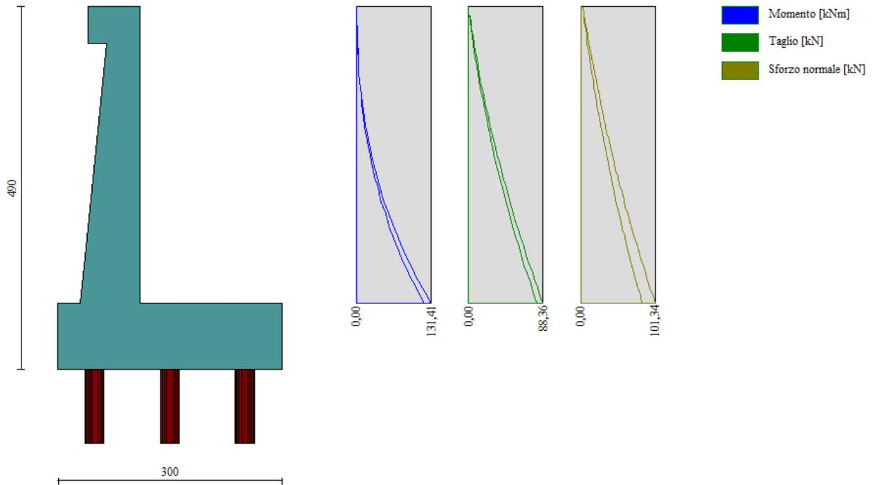
Figura 40- Involuppo delle sollecitazioni sul paramento del muro di sostegno in condizioni sismiche
