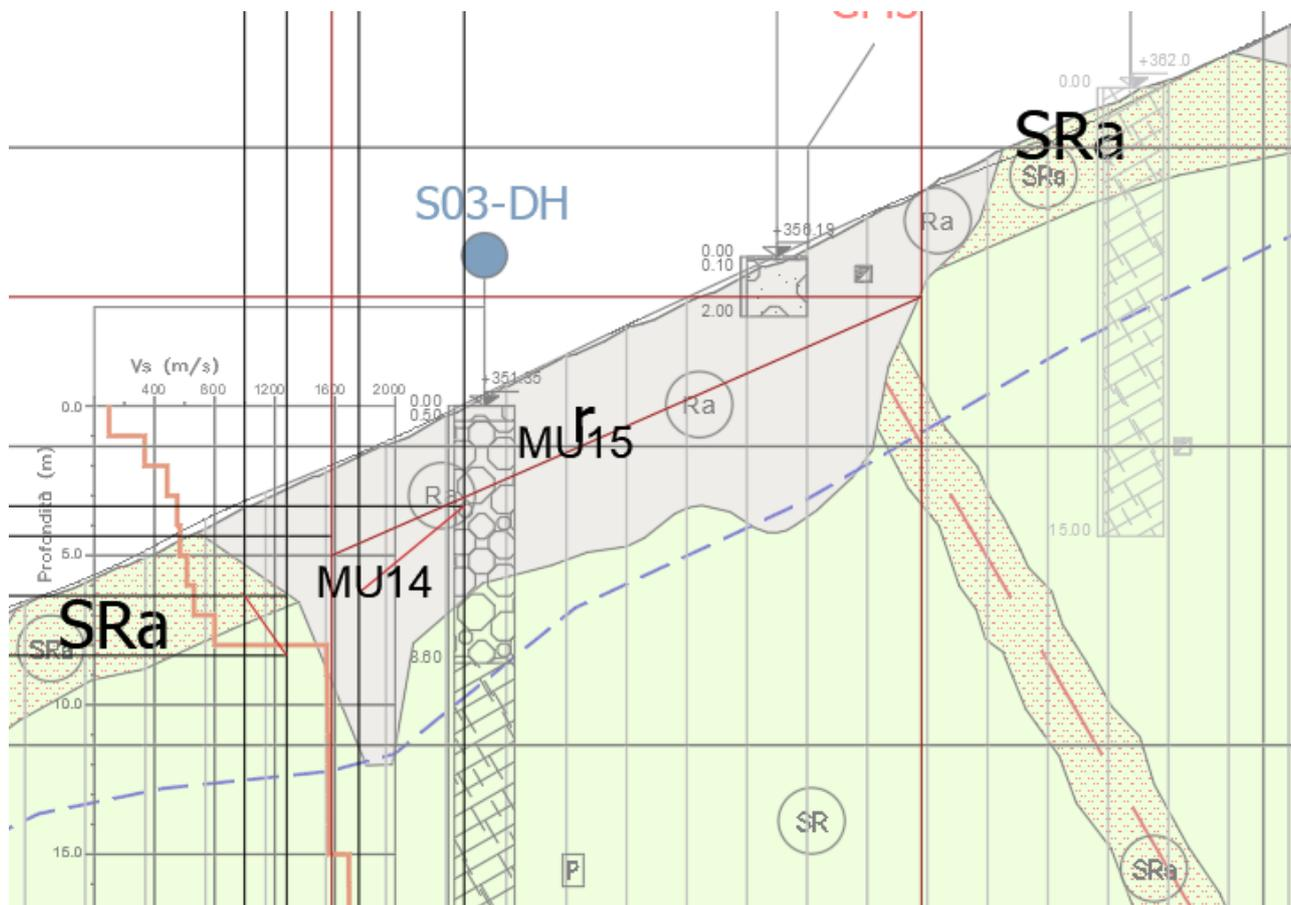
Figura 6: Stralcio profilo geotecnico con ubicazione opera
