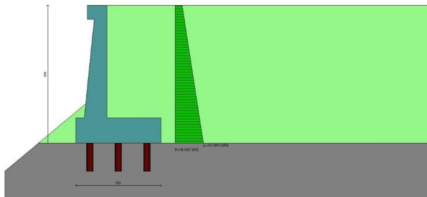
Fig. 5 - Diagramma delle pressioni (combinazione statica) (Combinazione n° 1)
