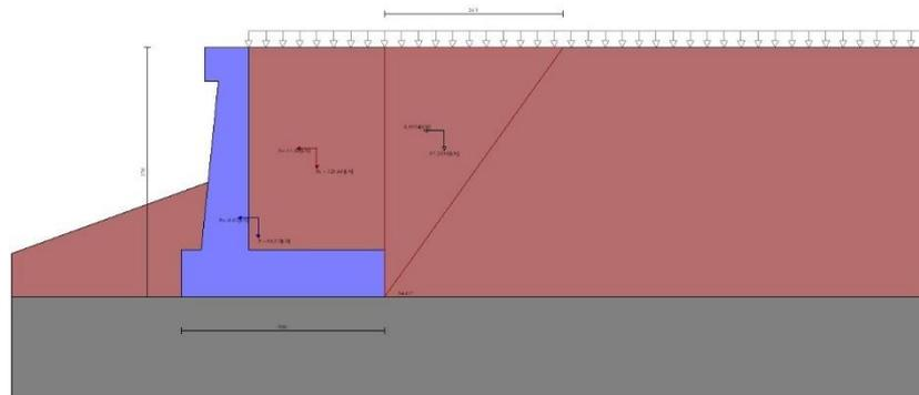
Fig. 13 - Cuneo di spinta (combinazione sismica) (Combinazione n° 2)
