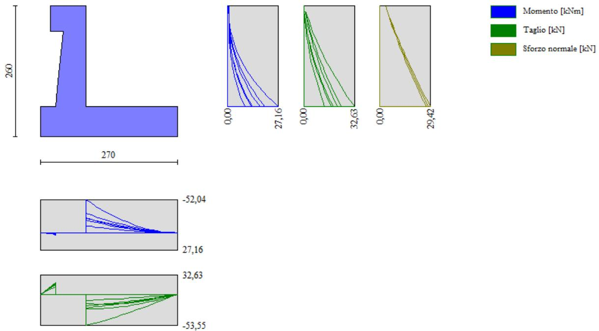
Figura 22: Involuppo diagrammi sollecitazioni- condizioni statiche e sismiche
