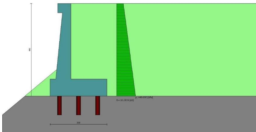
Fig. 10 - Diagramma delle pressioni (combinazione statica) (Combinazione n° 1)
