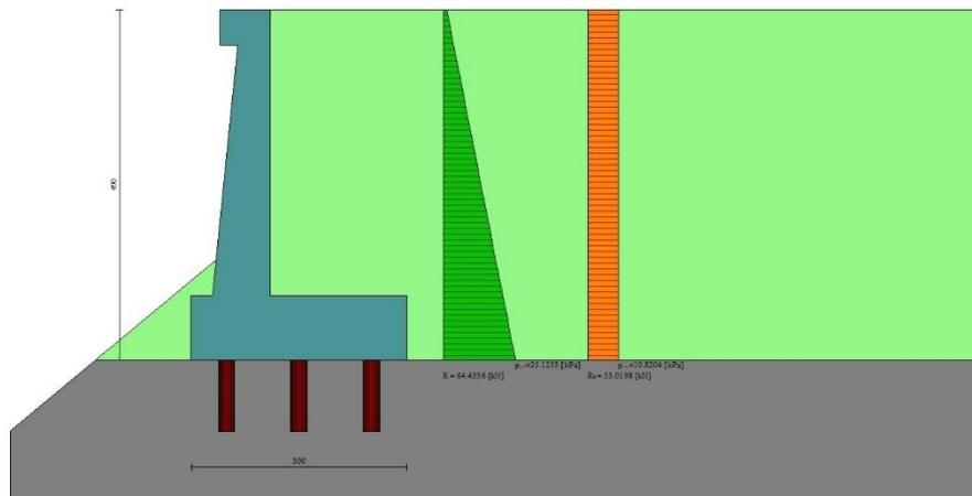
Fig. 7 - Diagramma delle pressioni (combinazione sismica) (Combinazione n° 1)
