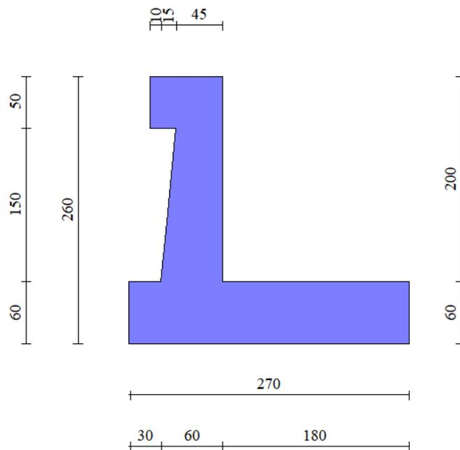
Figura 19: Geometria del muro di sostegno: sezione trasversale
