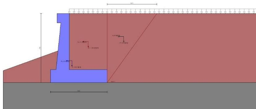
Fig. 5 - Cuneo di spinta (combinazione sismica) (Combinazione n° 2)
