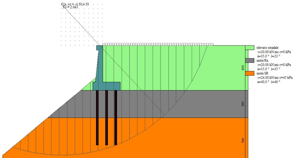
Figura 43: Verifica di stabilità globale \_ cond. sismica H+V (FS=2.043)
