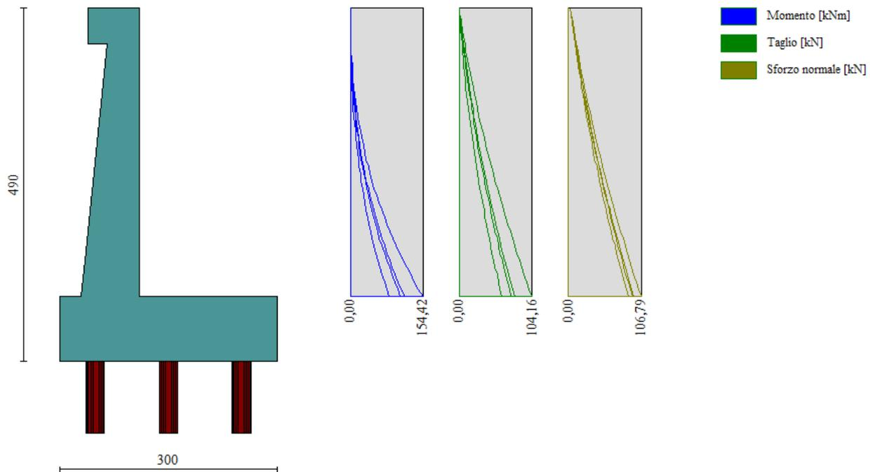
Figura 39 – Involuppo delle sollecitazioni sul paramento del muro di sostegno in condizioni statiche
