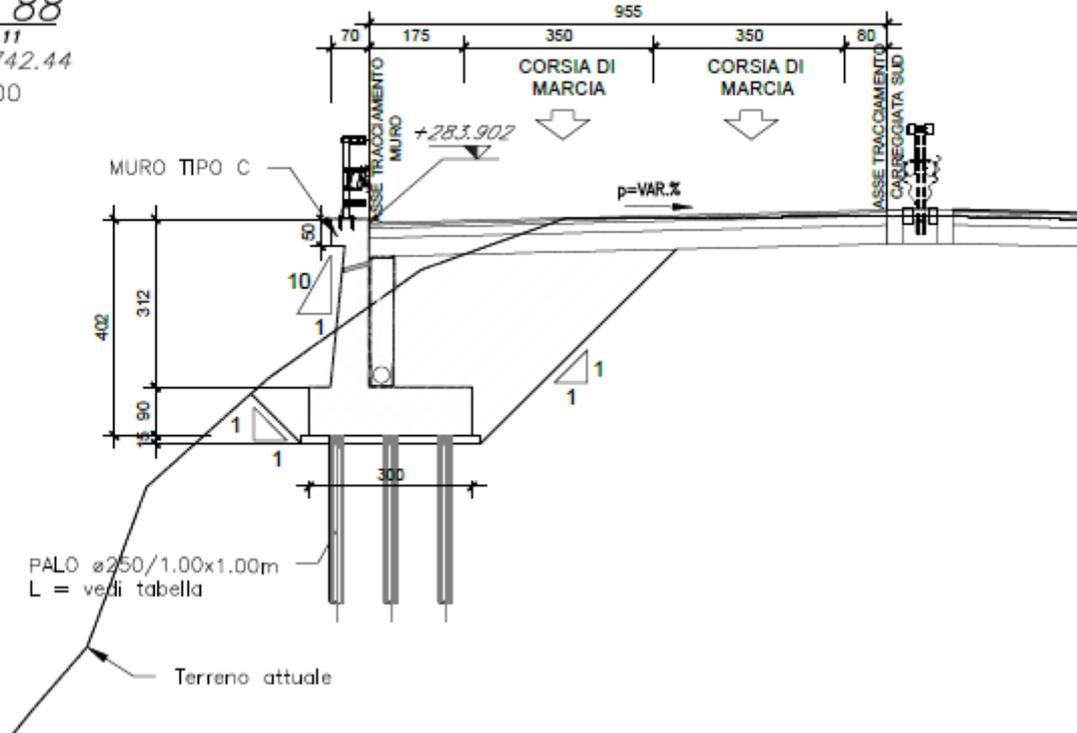
Figura 5: sezione trasversale muro tipologico C
