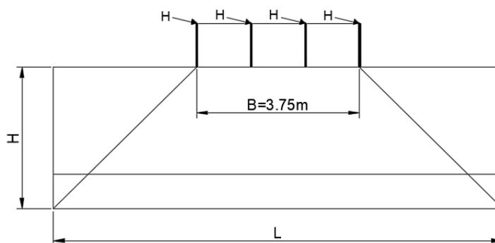
Figura 16: schema di ridistribuzione del carico d'urto
