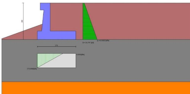
Fig. 4 - Diagramma delle pressioni (combinazione statica) (Combinazione n° 1)
