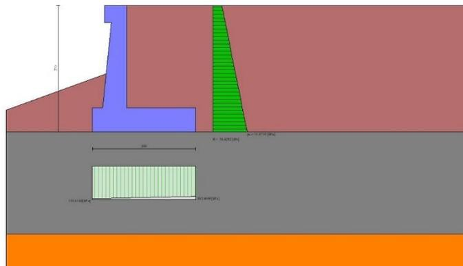
Fig. 12 - Diagramma delle pressioni (combinazione statica) (Combinazione n° 1)
