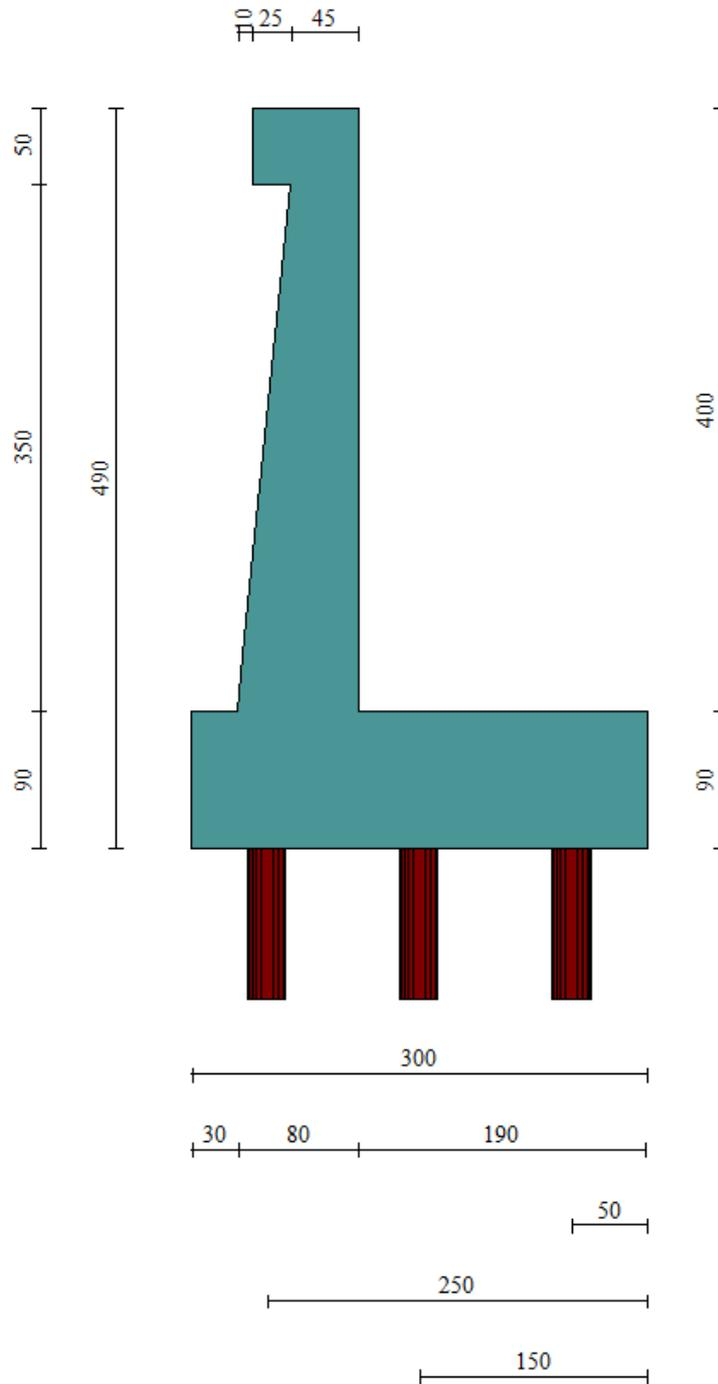
Figura 37: Geometria del muro di sostegno: sezione trasversale
