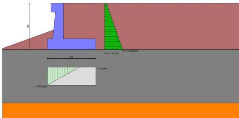
Fig. 10 - Diagramma delle pressioni (combinazione statica) (Combinazione n° 1)
