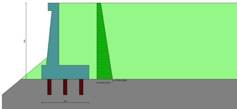
Fig. 16 - Diagramma delle pressioni (combinazione statica) (Combinazione n° 1)
