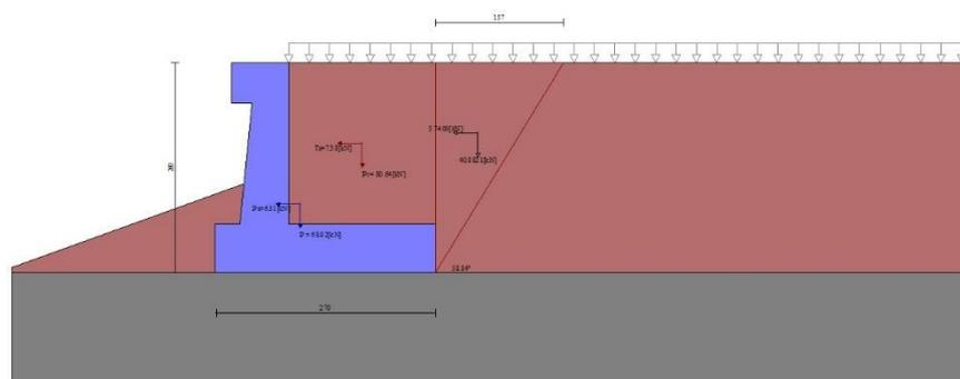
Fig. 5 - Cuneo di spinta (combinazione sismica) (Combinazione n° 2)
