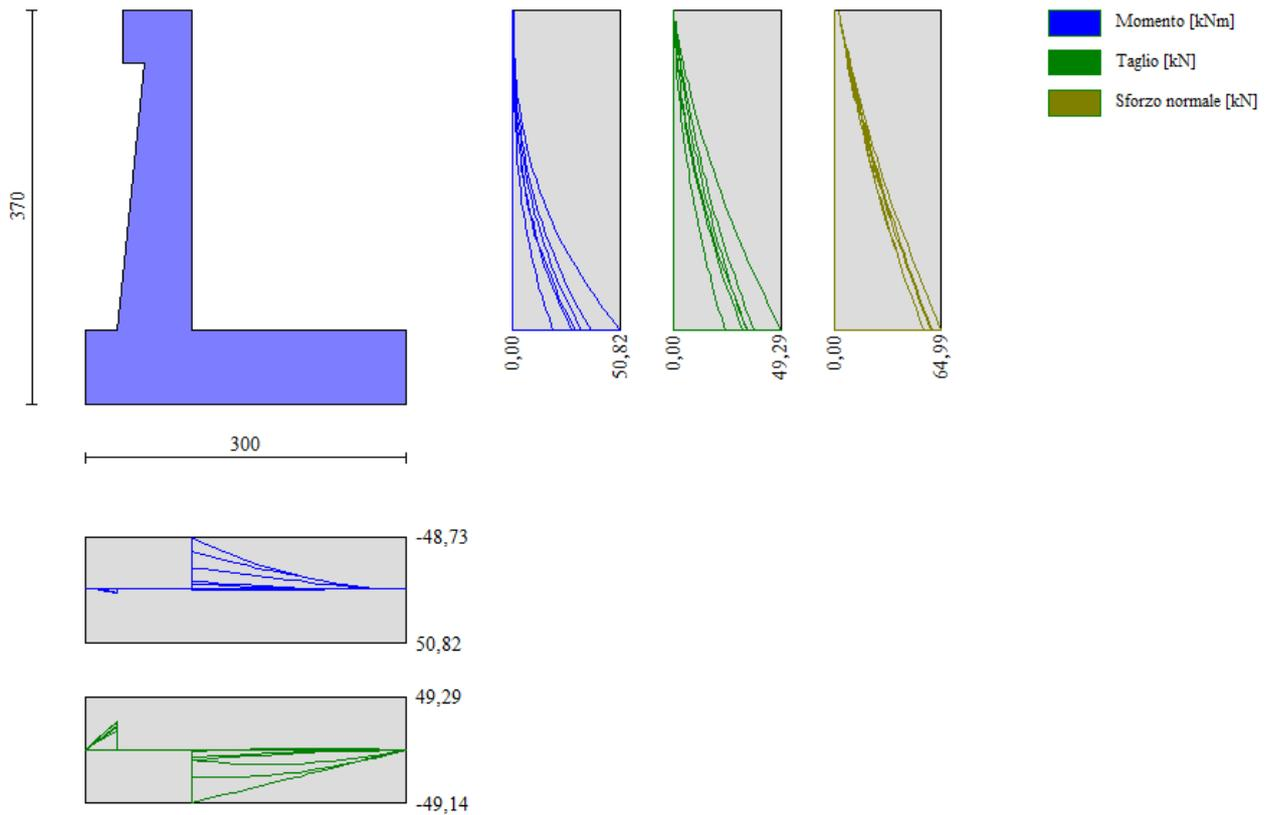
Figura 31: Involuppo diagrammi sollecitazioni- condizioni statiche e sismiche
