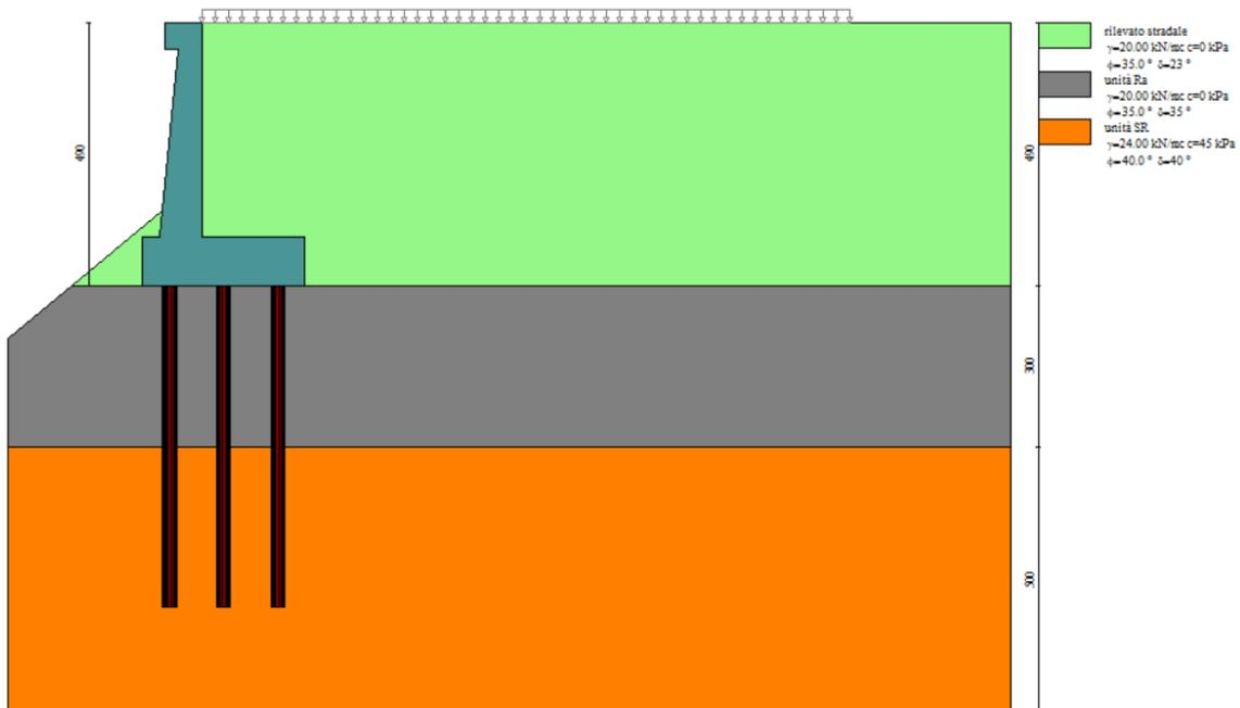
Figura 36: modello di calcolo muro tipologico C
