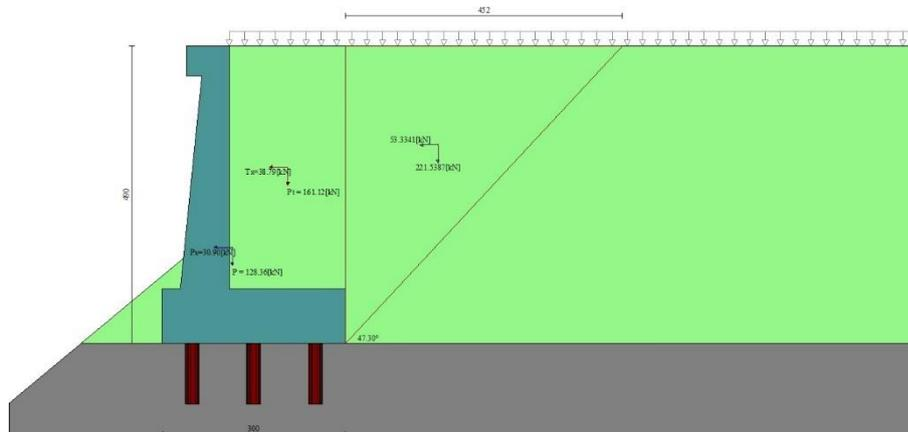
Fig. 6 - Cuneo di spinta (combinazione sismica) (Combinazione n° 1)
