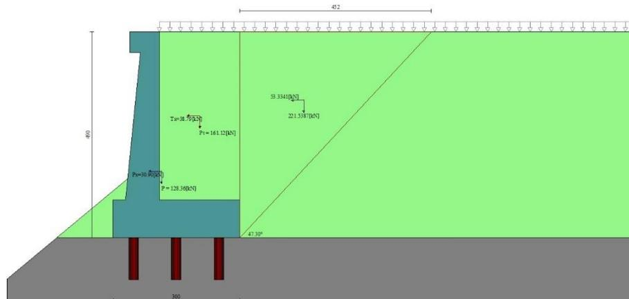
Fig. 23 - Cuneo di spinta (combinazione sismica) (Combinazione n° 1)
