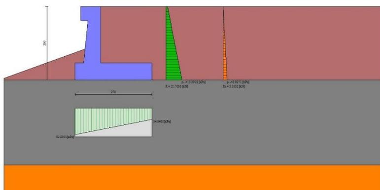
Fig. 6 - Diagramma delle pressioni (combinazione sismica) (Combinazione n° 2)
