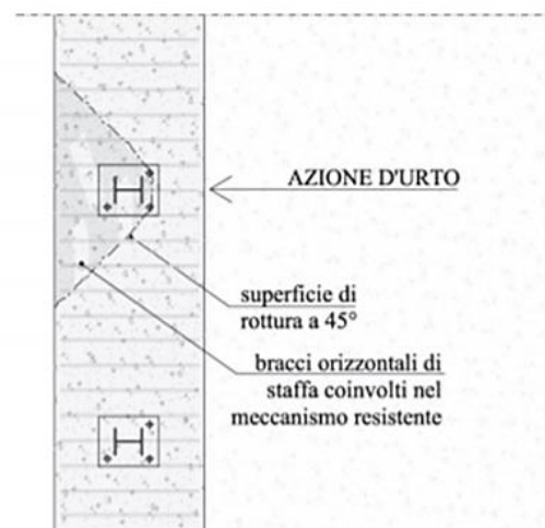
Cono di diffusione verifica staffe orizzontali
