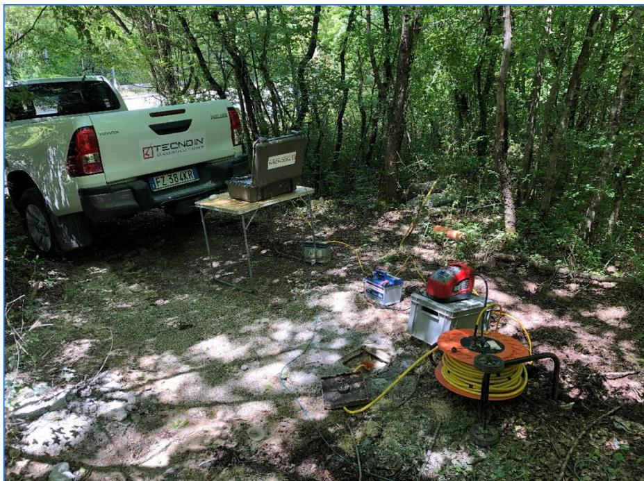
*Fig. 3.9 - Progetto Definitivo della "S.S. 4 Salaria — Adeguamento della piattaforma stradale e messa in sicurezza dal km 56+000 al km 64+000". Indagine sismica in foro SO7-DH.*
