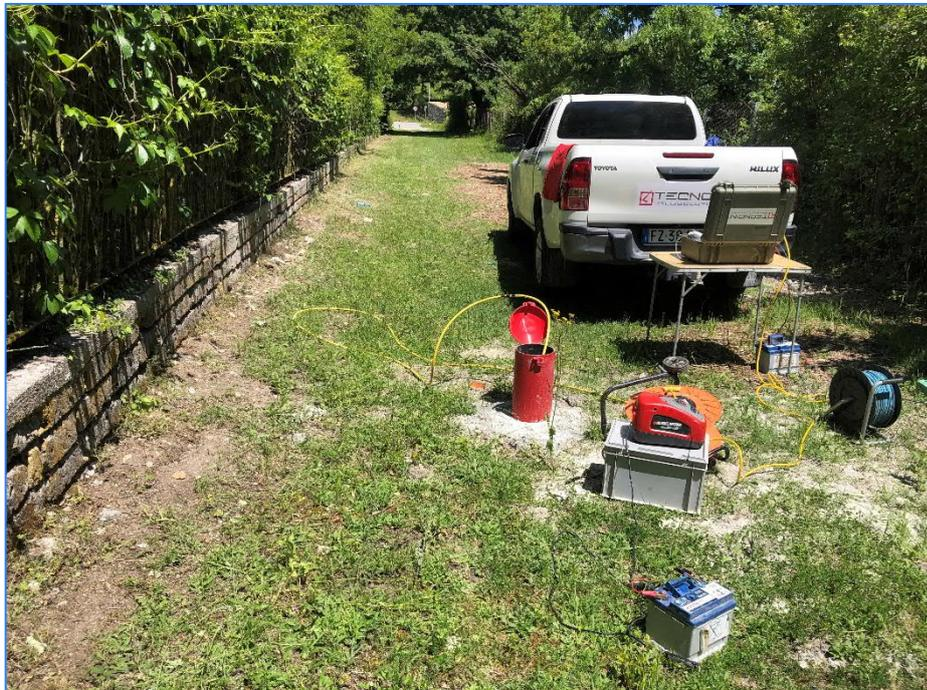
*Fig. 3.11 - Progetto Definitivo della "S.S. 4 Salaria — Adeguamento della piattaforma stradale e messa in sicurezza dal km 56+000 al km 64+000". Indagine sismica in foro S09-DH.*
