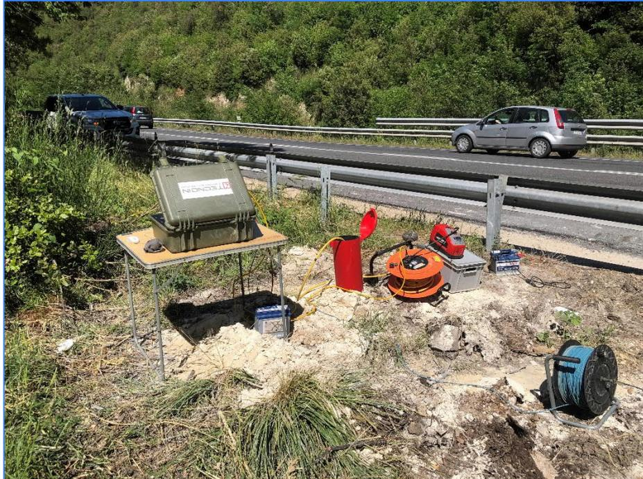
*Fig. 3.4 - Progetto Definitivo della "S.S. 4 Salaria — Adeguamento della piattaforma stradale e messa in sicurezza dal km 56+000 al km 64+000". Indagine sismica in foro S02-DH.*
