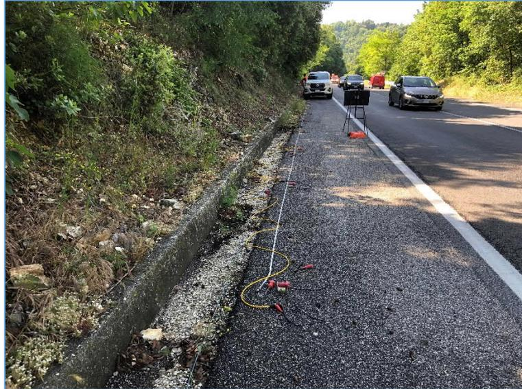
*Fig. 2.5 - Progetto Definitivo della "S.S. 4 Salaria — Adeguamento della piattaforma stradale e messa in sicurezza dal km 56+000 al km 64+000". Tomografia sismica. Profilo sismico RIFRA3.*
