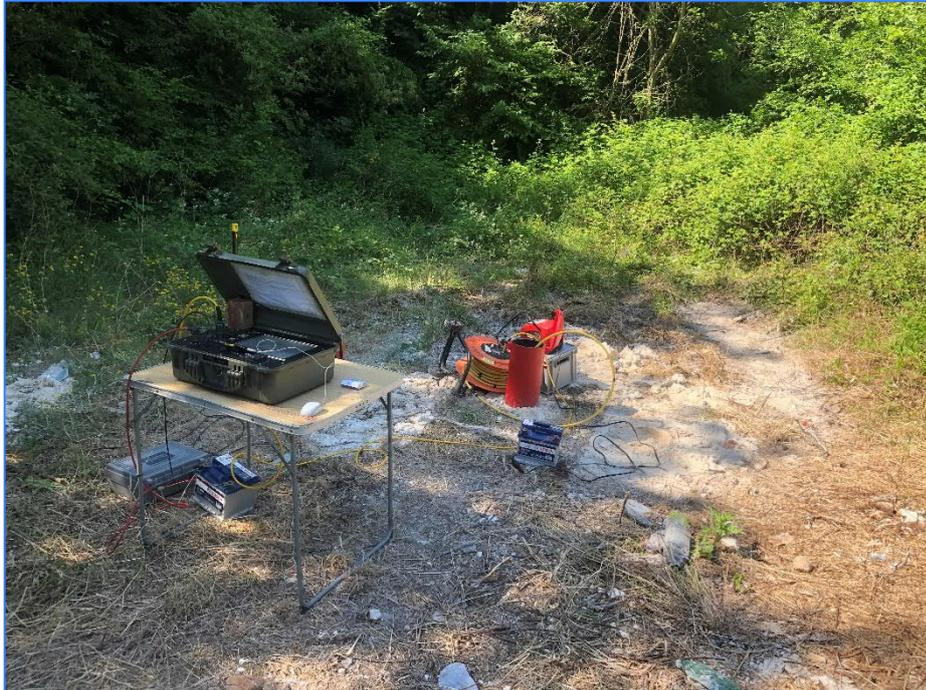
*Fig. 3.6 - Progetto Definitivo della "S.S. 4 Salaria — Adeguamento della piattaforma stradale e messa in sicurezza dal km 56+000 al km 64+000". Indagine sismica in foro S04-DH.*
