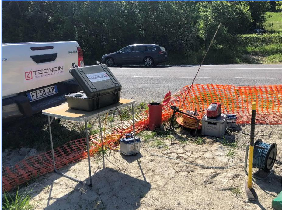
*Fig. 3.12 - Progetto Definitivo della "S.S. 4 Salaria — Adeguamento della piattaforma stradale e messa in sicurezza dal km 56+000 al km 64+000". Indagine sismica in foro S11-DH.*
