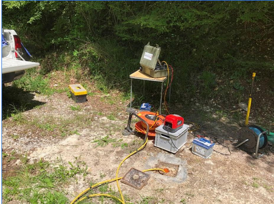
*Fig. 3.10 - Progetto Definitivo della "S.S. 4 Salaria — Adeguamento della piattaforma stradale e messa in sicurezza dal km 56+000 al km 64+000". Indagine sismica in foro S08-DH.*
