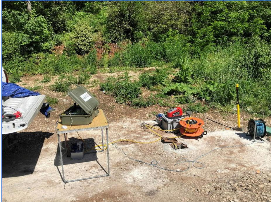
*Fig. 3.8 - Progetto Definitivo della "S.S. 4 Salaria — Adeguamento della piattaforma stradale e messa in sicurezza dal km 56+000 al km 64+000". Indagine sismica in foro SO6-DH.*
