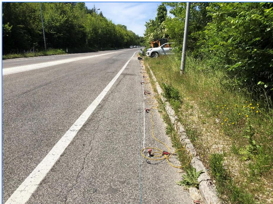
*Fig. 5.4 - Progetto Definitivo della "S.S. 4 Salaria — Adeguamento della piattaforma stradale e messa in sicurezza dal km 56+000 al km 64+000". Indagine MASW02*
