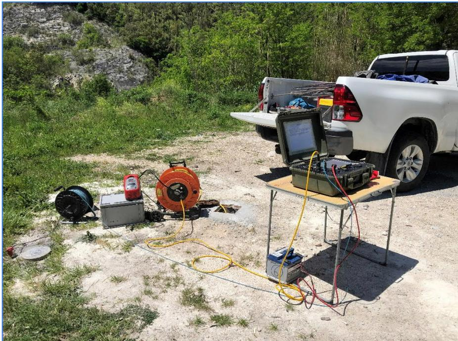
*Fig. 3.7 - Progetto Definitivo della "S.S. 4 Salaria — Adeguamento della piattaforma stradale e messa in sicurezza dal km 56+000 al km 64+000". Indagine sismica in foro S05-DH.*
