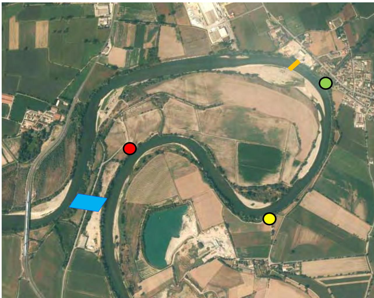
Planimetria con individuazione del limite di rigurgito (linea arancione), impianto idroelettrico in progetto (azzurro), la nuova posizione del pontile di Bertónico (pallino rosso) e la nuova posizione del pontile di Gombito (pallino giallo), in verde la posizione attuale del pontile di gombito.
