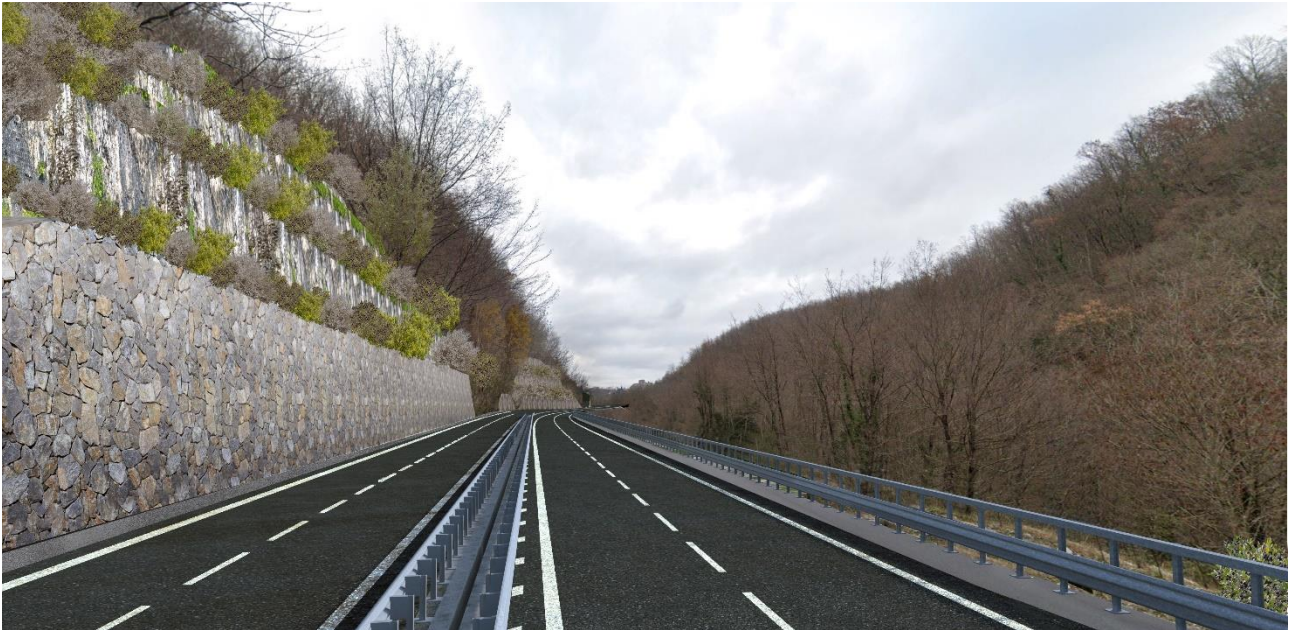
Figura 2 – Configurazione finale delle trincea (schema illustrativo)
